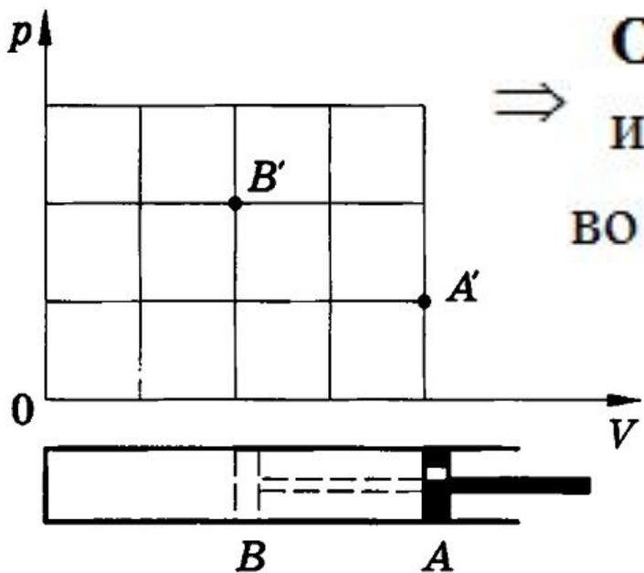
**Ответ:** в первом случае наблюдается изотермический процесс  $T = Const$ ; а во втором случае – адиабатный процесс
