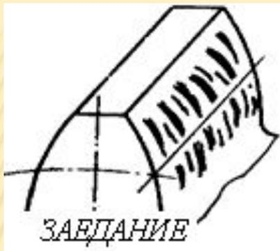
**Заедание** наблюдается преимущественно у высоконагруженных и высокоскоростных передач. В месте контакта зубьев передач развивается высокая температура, способствующая разрыву масляной пленки и образованию металлического контакта. Здесь происходит как бы сваривание частиц металла с последующим отрывом их от одной из поверхностей. Образовавшиеся наросты задирают рабочие поверхности зубьев в направлении скольжения.
