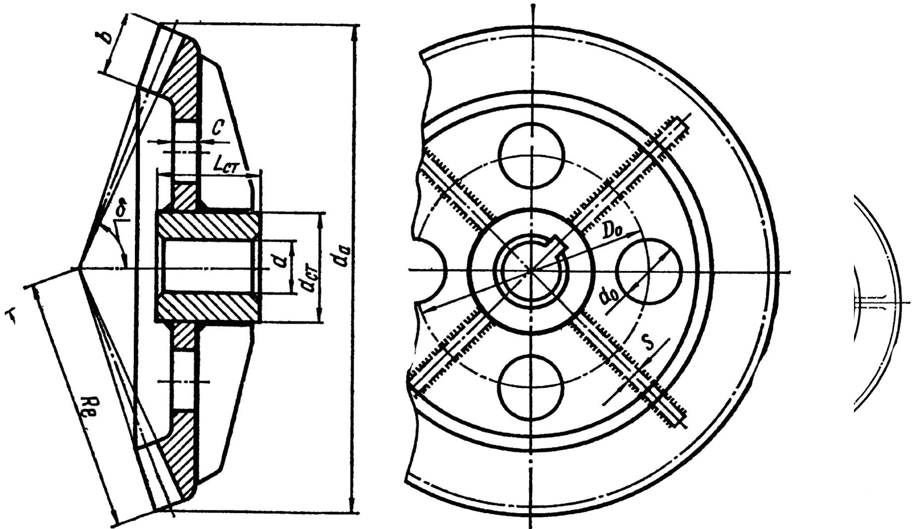
Зубчатое колесо коническое сварное:
