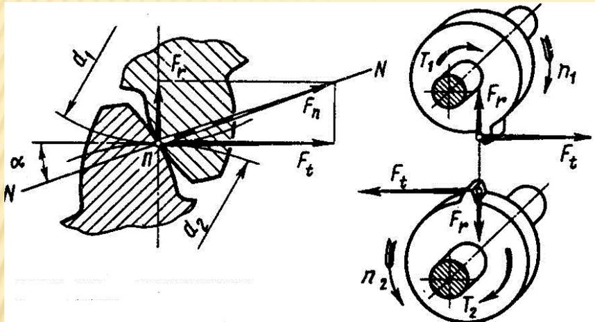
Так как силы трения между зубьями малы, то силу давления между ними  $F_n$  можно считать направленной по общей нормали к соприкасающимся поверхностям зубьев, т.е. по линии зацепления. Силы, действующие в зацеплении, принято прикладывать в полюсе зацепления. При этом нормальную силу  $F_n$  переносят в полюс и раскладывают на окружную  $F_t$  и радиальную  $F_r$  силы.
