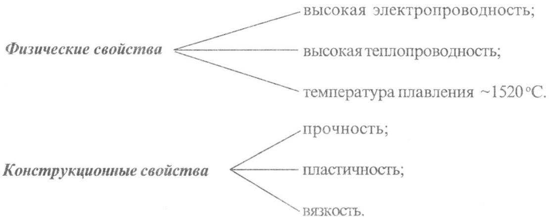
Необходимые конструкционные свойства стали достигаются путем изменения содержания углерода и легированием.
