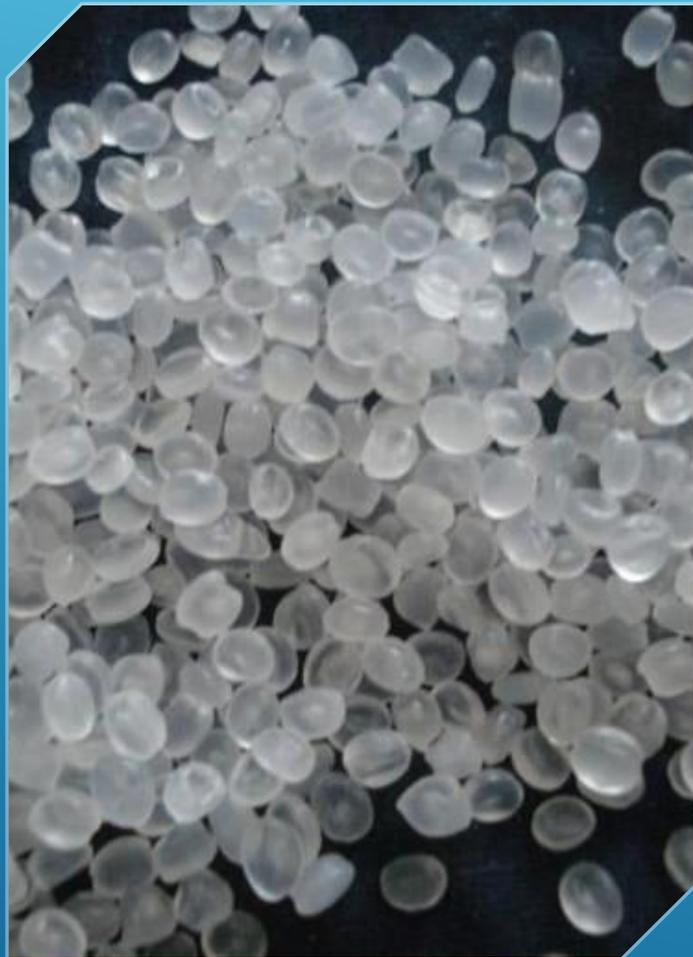
В ОТЛИЧИЕ ОТ ПОЛИЭТИЛЕНА, ПОЛИПРОПИЛЕН МЕНЕЕ ПЛОТНЫЙ (ПЛОТНОСТЬ 0,91 Г/СМ<sup>3</sup>, ЧТО ЯВЛЯЕТСЯ НАИМЕНЬШИМ ЗНАЧЕНИЕМ ВООБЩЕ ДЛЯ ВСЕХ ПЛАСТМАСС), БОЛЕЕ ТВЁРДЫЙ (СТОЕК К ИСТИРАНИЮ), БОЛЕЕ ТЕРМОСТОЙКИЙ (НАЧИНАЕТ РАЗМЯГЧАТЬСЯ ПРИ 140 °С, ТЕМПЕРАТУРА ПЛАВЛЕНИЯ 175 °С), ПОЧТИ НЕ ПОДВЕРГАЕТСЯ КОРРОЗИОННОМУ РАСТРЕСКИВАНИЮ. ОБЛАДАЕТ ВЫСОКОЙ ЧУВСТВИТЕЛЬНОСТЬЮ К СВЕТУ И КИСЛОРОДУ (ЧУВСТВИТЕЛЬНОСТЬ ПОНИЖАЕТСЯ ПРИ ВВЕДЕНИИ СТАБИЛИЗАТОРОВ).
