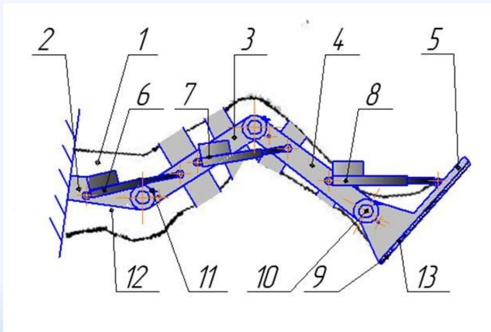
1 – Нога человека; 2 - Стойка; 3 - Бедренное звено; 4 - Голень; 5 - Стопа; 6, 7, 8 - Приводы линейного перемещения; 9 - Резиновая подошва; 10 - Датчик угла поворота (энкодер); 11 - Предохранительный концевой датчик; 12- Ремни для закрепления на ноге человека; 13 - Датчик нагрузки на опорную пяту.
