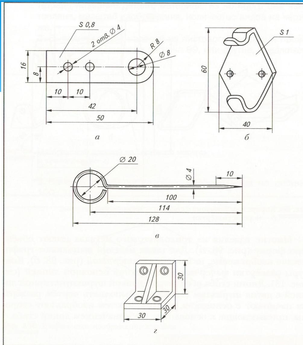
Рис. 97. Графические изображения деталей из металла и пластмассы:
