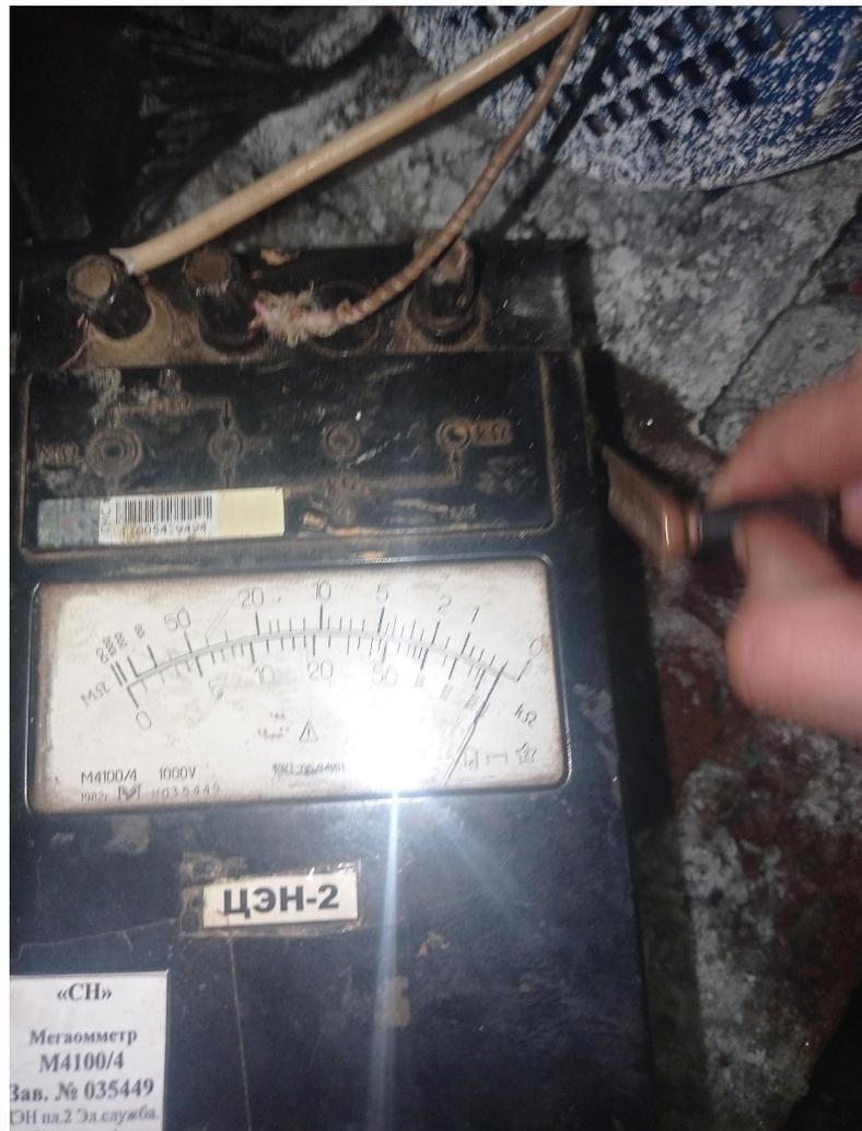
При проверке электродвигателя мегаомметр показал 0 сопротивление изоляции статора из чего следует что электродвигатель сгорел. Приступили к замене.
