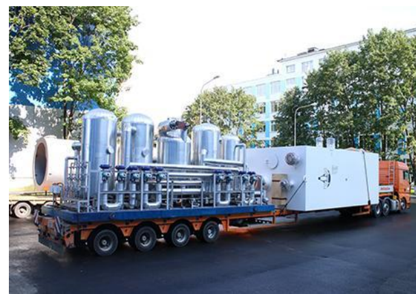
Блоки ожижения поставляются в блочно-модульном исполнении с максимальной заводской готовностью
