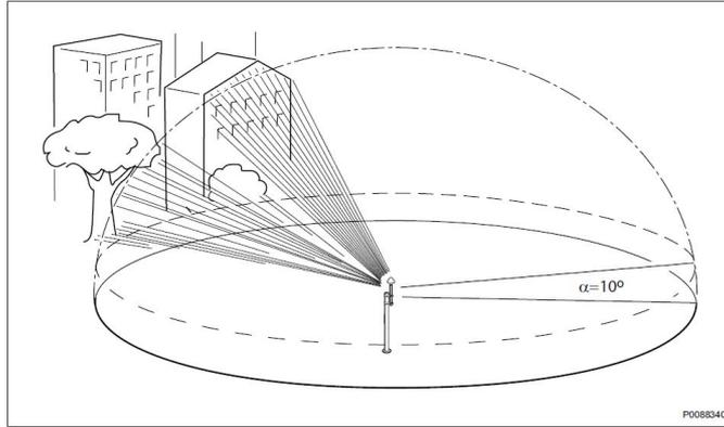
Антенна GPS / GNSS должна располагаться в направлении, относительно антенны RBS, где усиление антенны RBS составляет менее 0 dBi, как показано на рисунках. Для активной антенны GPS/GNSS требуется расстояние изоляции **не менее 1 м** от других антенн по горизонтали или вертикали.
