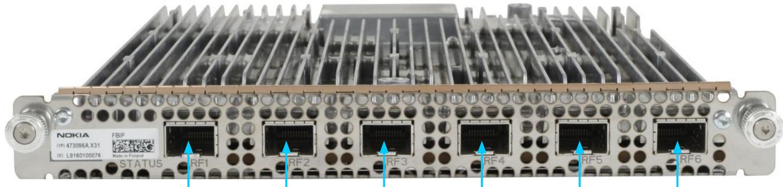
Для подключения радиомодулей RFM/RRH использовать SFP типа FOUC (9,8 Гбит/с)
