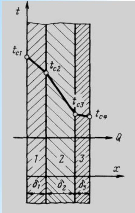
Рис. 8.3. Распределение температуры по толщине многослойной плоской стенки
