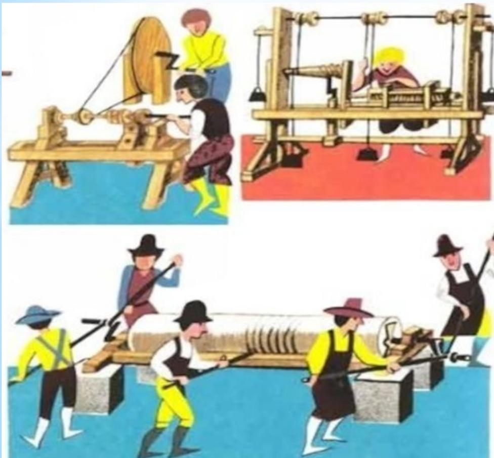
Токарные станки были изобретены и применялись ещё в глубокой древности. Они были очень просты по устройству, весьма несовершенны в работе и имели вначале ручной, а в последствии ножной привод.
