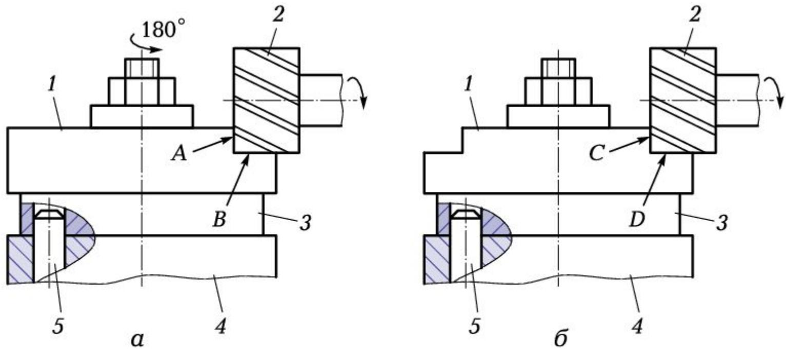
Рис. 1.2. Схемы (а, б) обработки заготовки в двух позициях:
