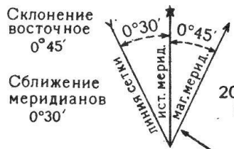
схема сближения меридианов и магнитного склонения
