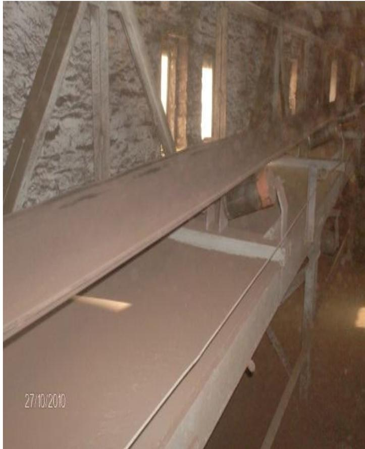
Огарок из обжигового цеха после сухой классификации и измельчения в шаровых мельницах транспортируется в цех выщелачивания цинкового огарка ленточным транспортером по галерее до накопительных огарочных бункеров.
