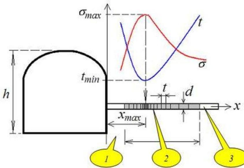
*Определение глубины расположения максимальных действующих напряжений от контура выработки по дискованию керна:*
