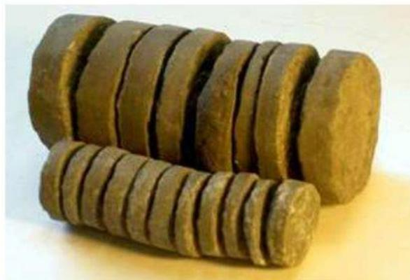
Чем больше действующие напряжения, тем интенсивнее процесс образования дисков, тем меньше толщина дисков керна. При равных напряжениях толщина дисков больше у керна большего диаметра.
