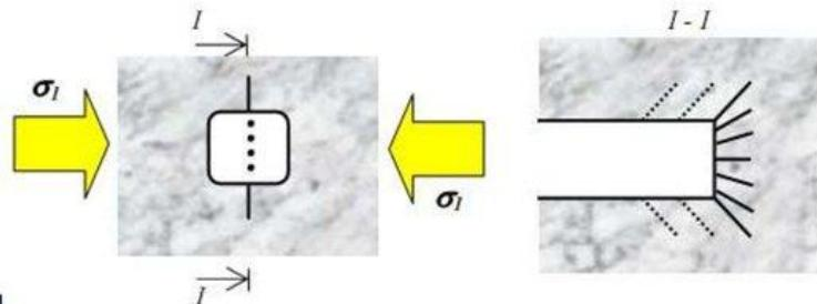
Схемы камуфлетного взрывания шпуров для разгрузки горизонтальных напряжений:
