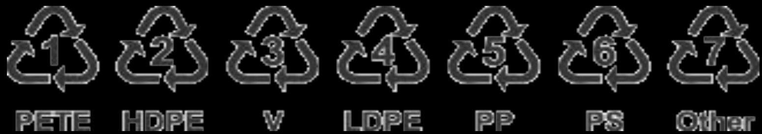
Рис. 8 Идентификационная маркировка пластиков SPI (США)
