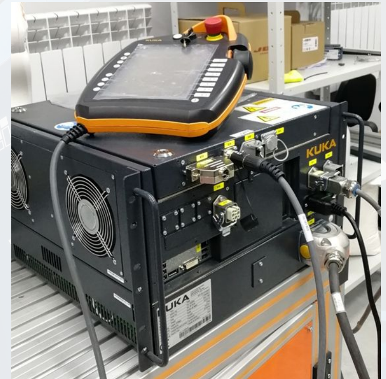
Контроллер роботизированного манипулятора
