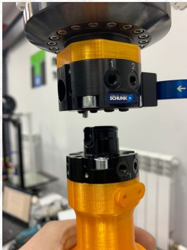
Система быстросъемного крепления на манипулятор
