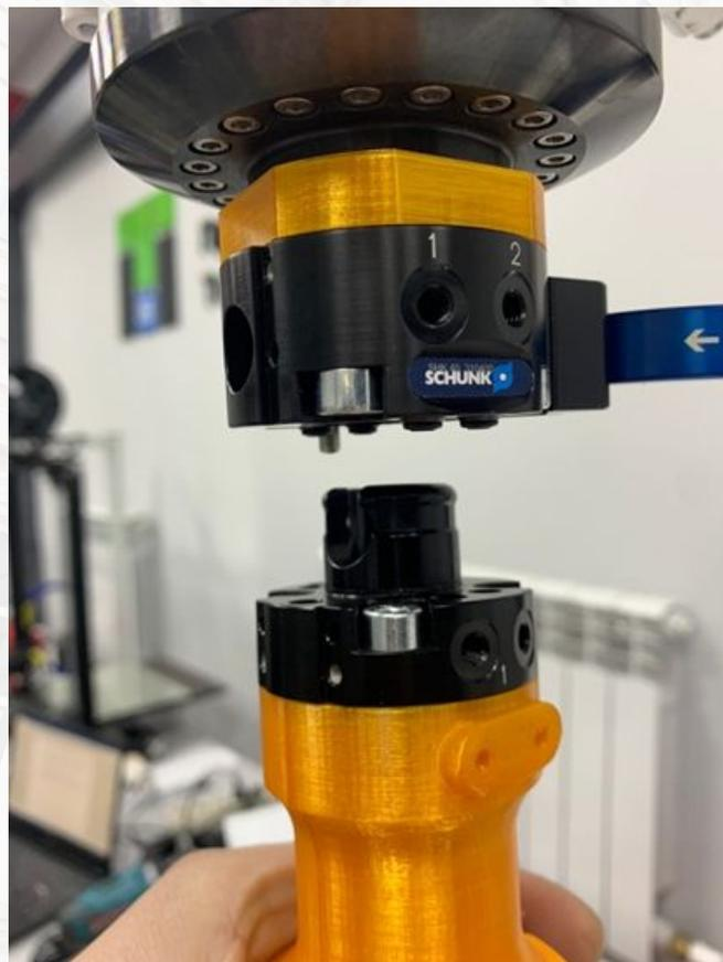
Система быстросъемного крепления на манипулятор
