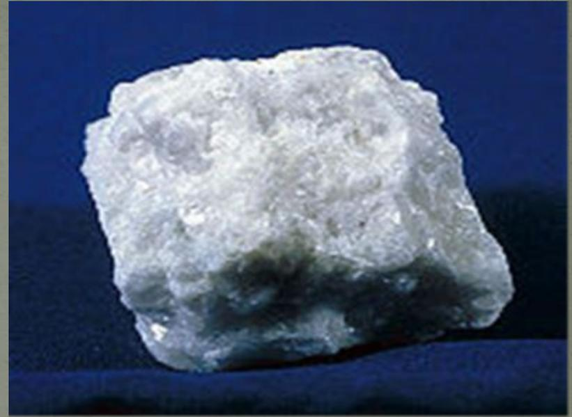
Мрамор – метаморфическая горная порода, состоящая только из кальцита  $\text{CaCO}_3$ . При перекристаллизации доломита  $\text{CaMg}(\text{CO}_3)_2$  образуются доломитовые мраморы.
