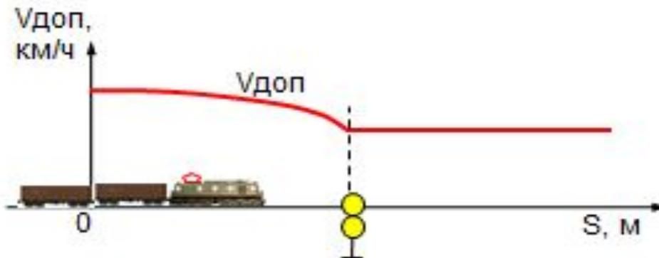
Расчетная скорость зависит от допускаемой скорости по стрелочному переводу и местоположения этого перевода.
