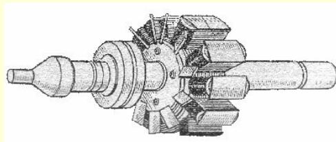
Название «**синхронная машина**» связано с тем, что ротор вращается **с такой же** скоростью, с какой вращается магнитное поле, т.е. **синхронно** с полем.
