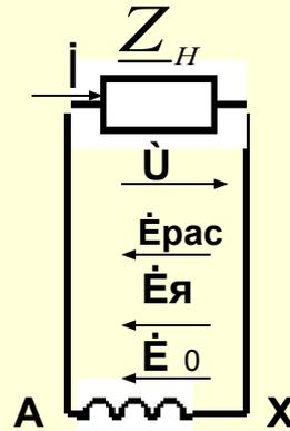
По второму закону Кирхгофа для замкнутой цепи фазы обмотки статора:
