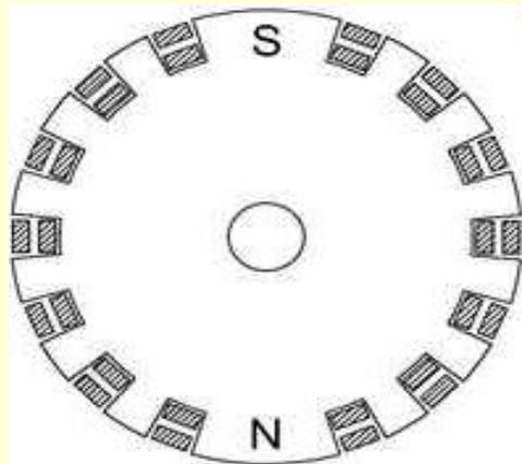
**Неявнополюсный** – полюса ротора сформированы обмоткой распределенной в пазах цилиндрического ротора
