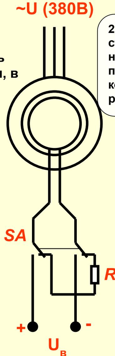
2. После подключения статора к сети  $\sim U$  СД начинает разгоняться подобно АД с короткозамкнутым ротором
