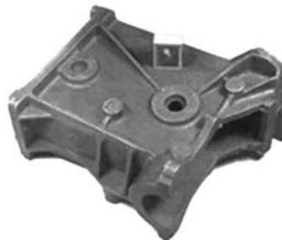
Кронштейн самолета Ил-76 сплав МЛ5
