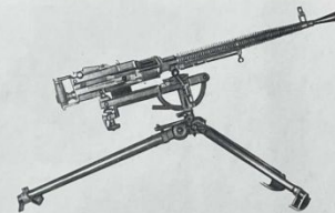
7,62-мм станковый пулемет системы Дегтярева образца 1939 г. (ДС)
