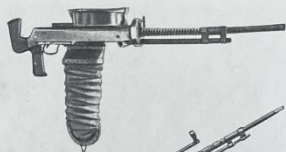
7,62-мм авиационный турельный пулемет системы Дегтярева образца 1928 г. ДА (без прицела и швартового устройства)
