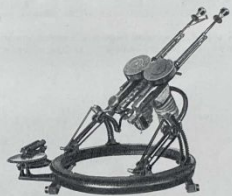
Спаренная турельная установка двух 7,62-мм авиационных пулеметов системы Дегтярева образца 1930 г. (ДА-2)
