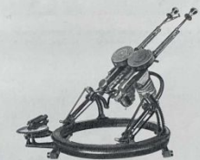
Спаренная турельная установка двух 7,62-мм авиационных пулеметов системы Дегтярева образца 1930 г. (ДА-2)
