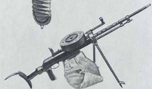
7,62-мм танковый пулемет системы Дегтярева образца 1929 г. (на сошках)
