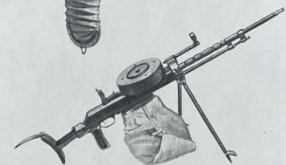
7,62-мм танковый пулемет системы Дегтярева образца 1929 г. (на шасси)
