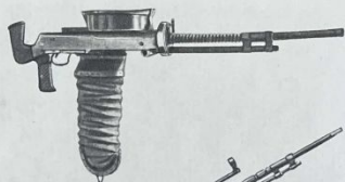
7,62-мм авиационный турельный пулемет системы Дегтярева образца 1928 г. ДА (без прицела и шкворневого устройства)
