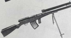
6,5-мм ручной пулемёт системы Фёдорова и Дегтярева с водяным охлаждением. Опытный образец 1922 г.
