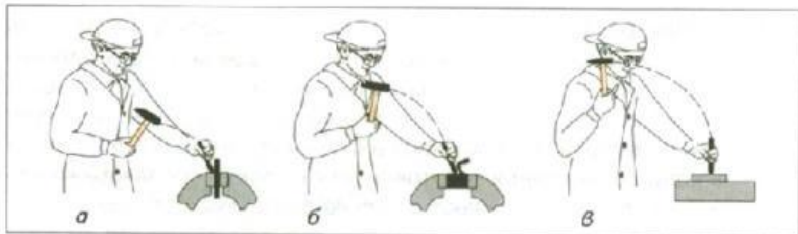
Рис. 69. Приемы рубки металла в тисках: а — кистевой удар; б — локтевой удар; в — плечевой удар
