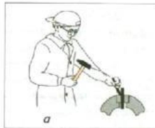
**Локтевой удар** применяют для разделения заготовки на части и срубания лишнего металла
