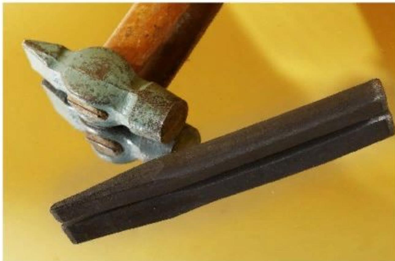
**Слесарное зубило** изготавливается из инструментальной углеродистой стали У7А или У8А. Оно состоит из трех частей: ударной, средней и рабочей. **Ударная часть** выполняется суживающейся кверху, а вершина ее (боек) — закругленной; за **среднюю часть** зубило держат во время рубки; **рабочая (режущая) часть** имеет клиновидную форму.
