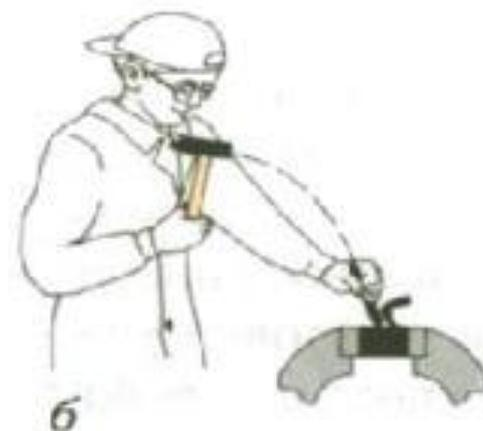
**Плечевой удар** используют для срубания толстых стружек, разрубания прутков и полос большой толщины
