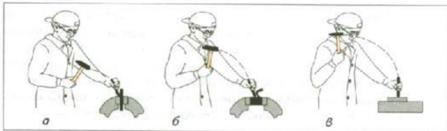
Рис. 69. Приемы рубки металла в тисках: а — кистевой удар; б — локтевой удар; в — плечевой удар
