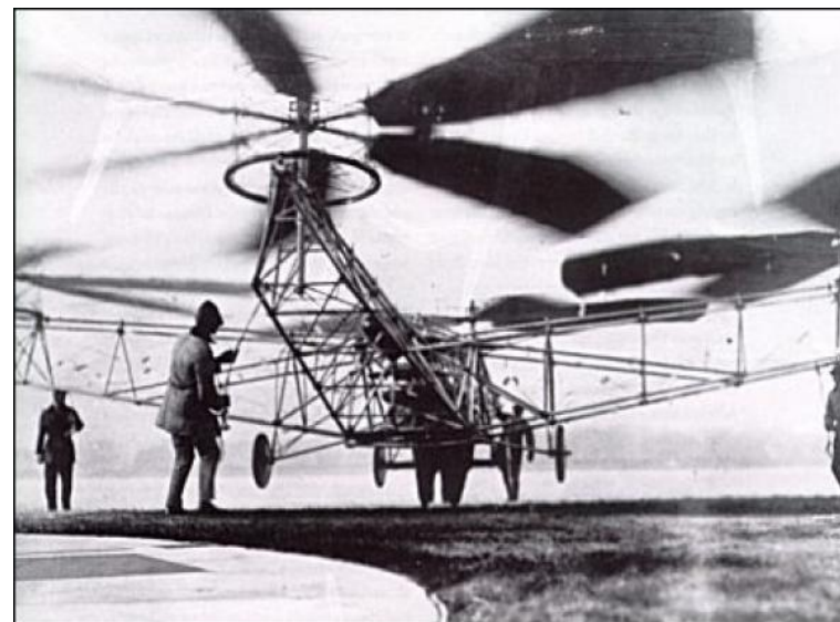
Испытания одного из первых вертолетов, оснащенного четырьмя винтами, начались в 1922 году.
