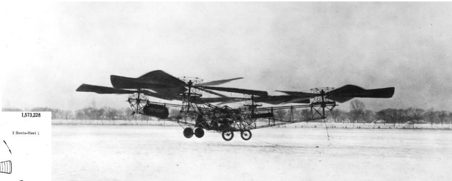
Испытания одного из первых вертолетов, оснащенного четырьмя винтами, начались в 1922 году.
