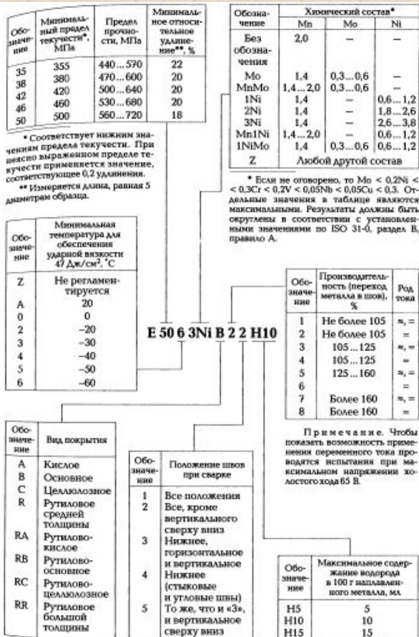
Рис. 7.4. Классификация покрытых электродов в соответствии с EN 499
