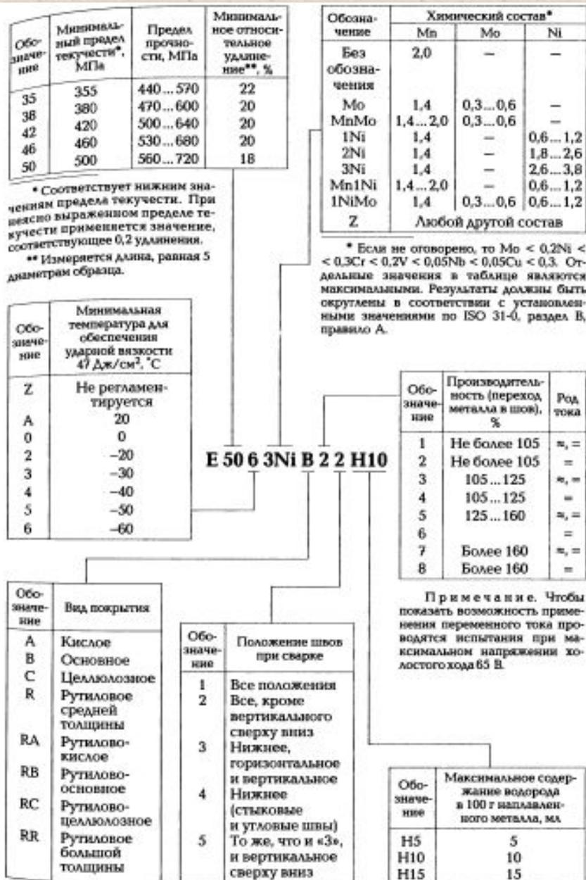
Рис. 7.4. Классификация покрытых электродов в соответствии с EN 499
