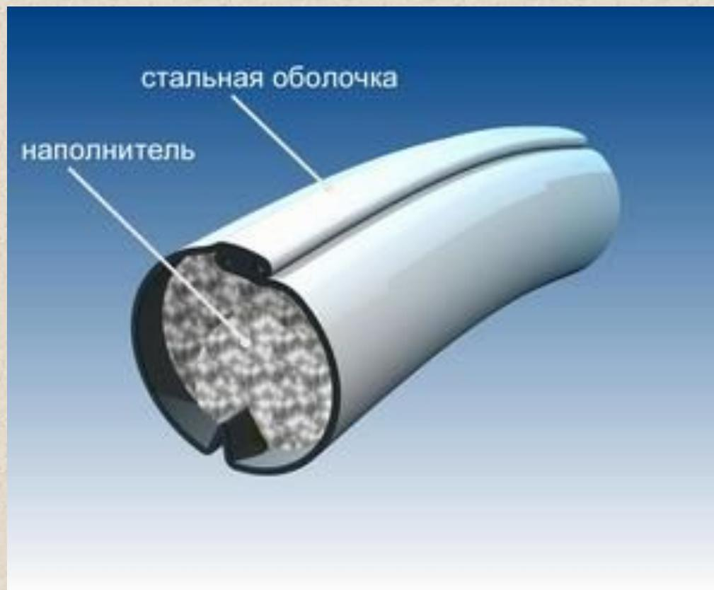
В условном обозначении сварочных порошковых проволок первые две буквы обозначают тип проволоки: **ПГ** - проволока для сварки в защитных газах; **ПС** - самозащитная проволока. Цифра соответствует пределу прочности металла шва в кгс/мм<sup>2</sup>.
