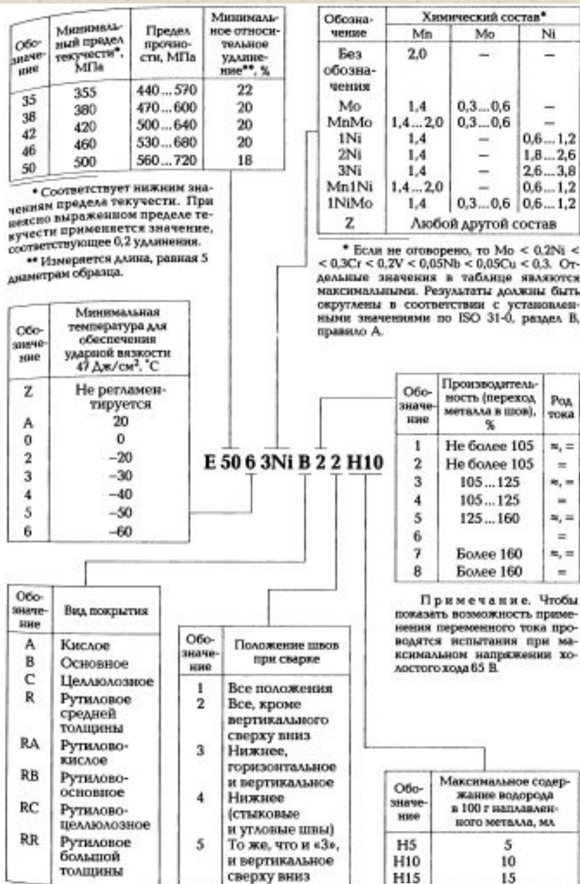
Рис. 7.4. Классификация покрытых электродов в соответствии с EN 499
