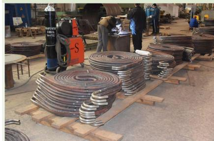
В настоящее время в производстве выполняется заказ по изготовлению спиралей для энергоблока № 3 Балаковской АЭС, который отключен от сети для перегрузки топлива и проведения планово-предупредительного ремонта.
