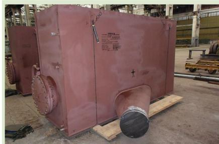
В 2018 году коллектив ОП Моршанск ООО «КомплектЭнерго» изготовил и поставил отдельные узлы для конденсатора «блочно-модульного» исполнения «К-12900» для Армянской АЭС Данное оборудование было поставлено в рамках программы по продлению срока эксплуатации паровой турбины К-220-44-1 энергоблока №2 с целью повышения экономичности и надежности.
