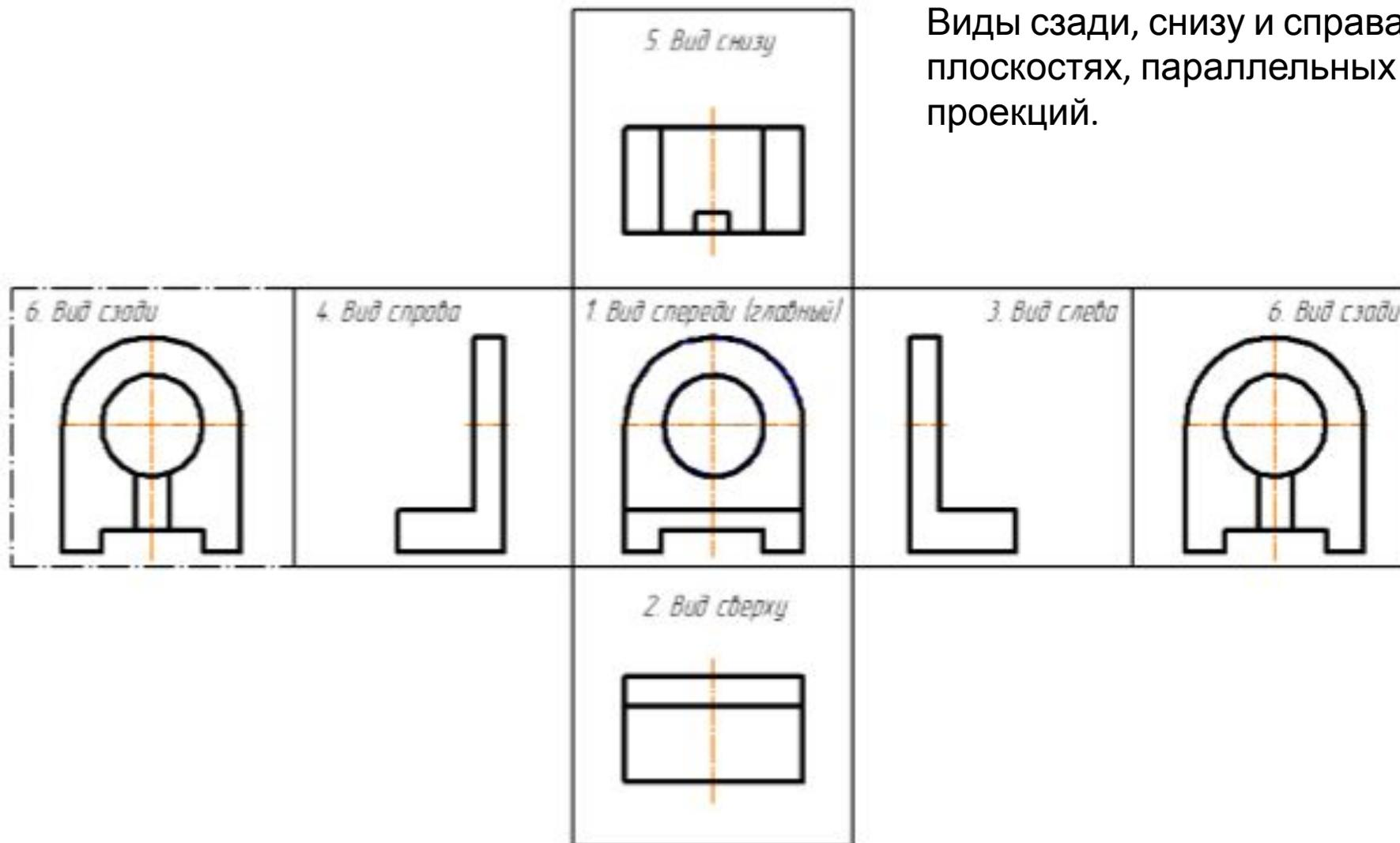
Виды сзади, снизу и справа получают на плоскостях, параллельных плоскостям проекций.
