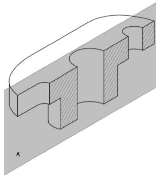
Разрез простой не обозначают, если секущая плоскость совпадает с плоскостью симметрии предмета, а изображение размещено в проекционной связи.
