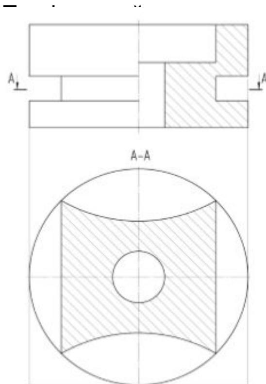
Плоскость параллельна профильной плоскости проекций.
