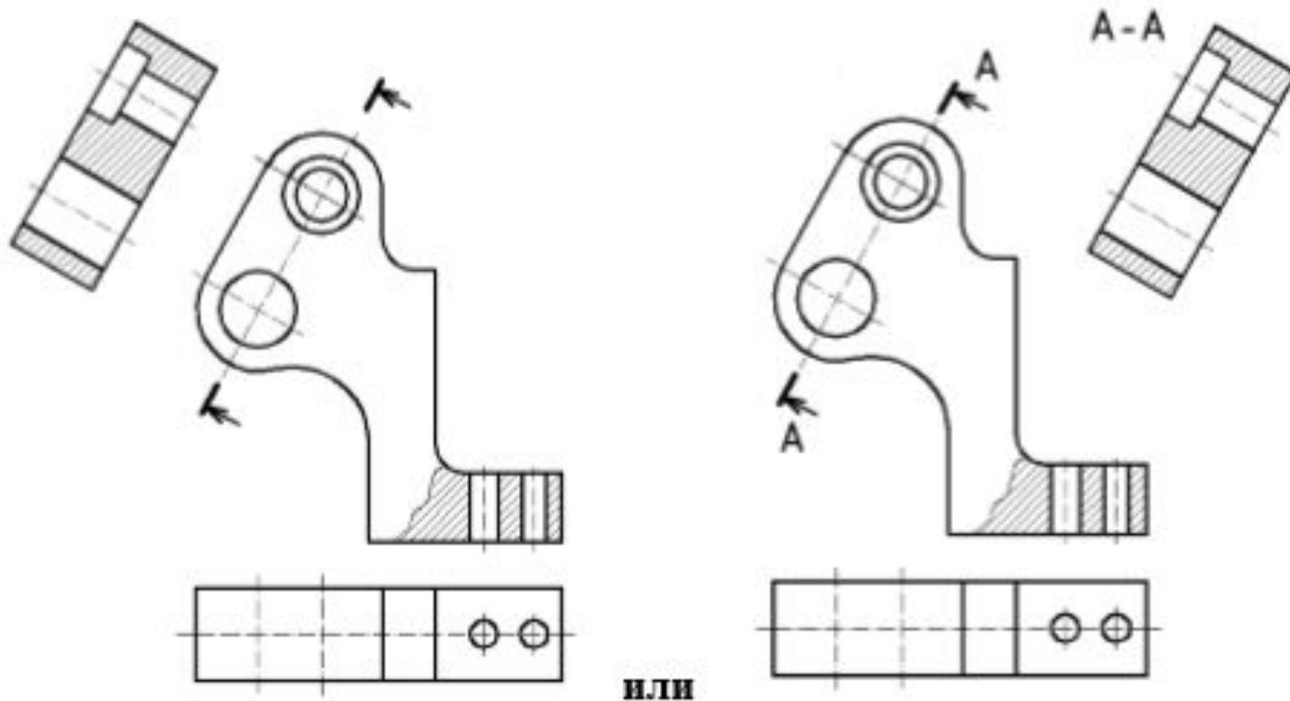
Последовательность построений: 1 Выбрать положение секущей плоскости. 2 Установить направление проецирования. 3 «Удалить» часть предмета, расположенную между секущей плоскостью и наблюдателем. 4 Фигуру сечения выделить штриховкой. 5 Дополнить разрез линиями, изображающими то, что видимо за секущей плоскостью. 6 При необходимости разрез обозначить.
