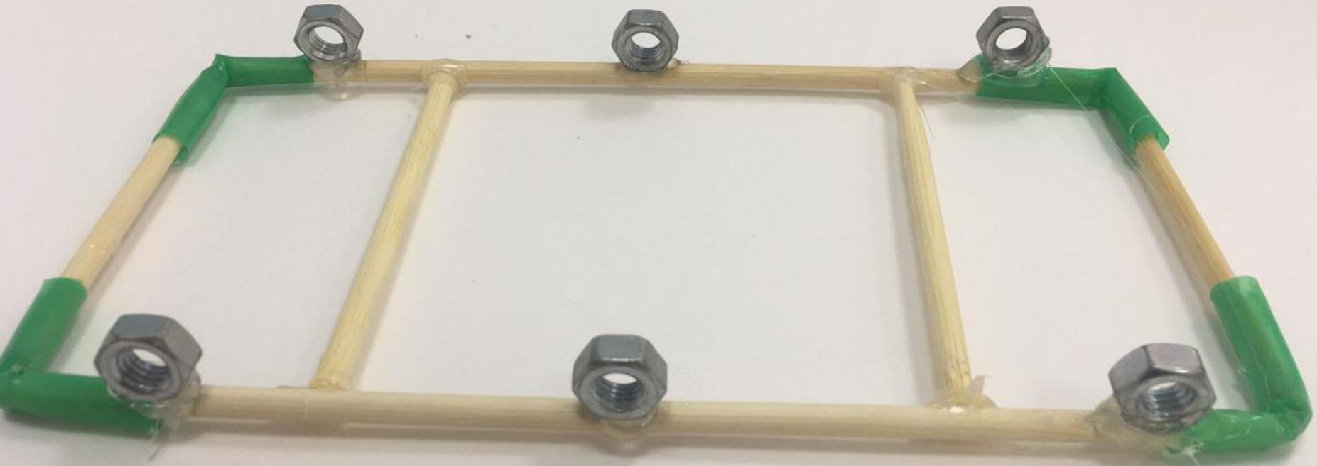
Соединяем верхнюю и нижнюю раму по гайкам
