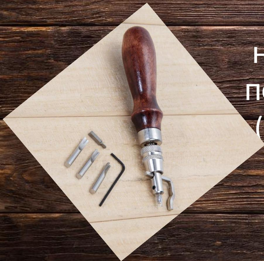
Инструмент с набором бит для подрезания краев (снятие фаски) и продавливания ЛИНИЙ.
