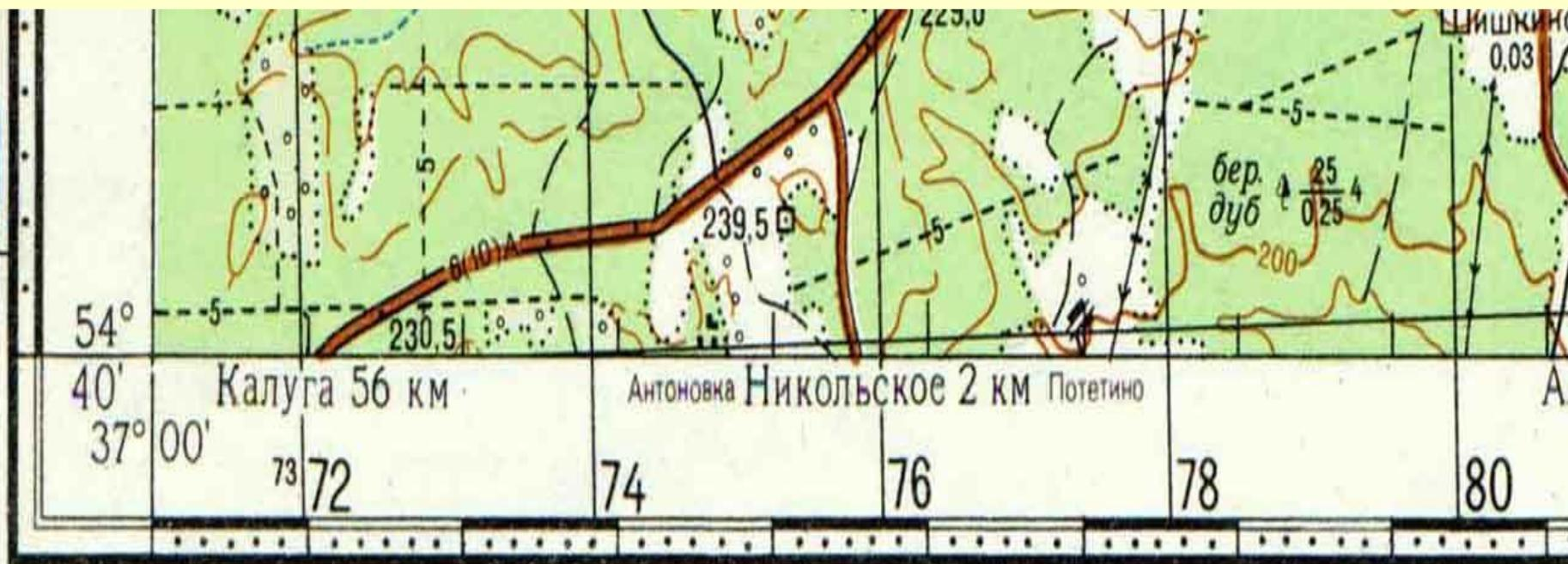
Склонение на 1983 г. восточное  $7^{\circ}38'$  (1-27). Среднее сближение меридианов западное  $1^{\circ}26'$  (0-24). При прикладывании буссоли (компаса) к вертикальным линиям координатной сетки среднее отклонение магнитной стрелки восточное  $9^{\circ}04'$  (1-51). Годовое изменение склонения западное  $0^{\circ}01'$  (0-00). Поправка в дирекционный угол при переходе к магнитному азимуту минус (1-51).
