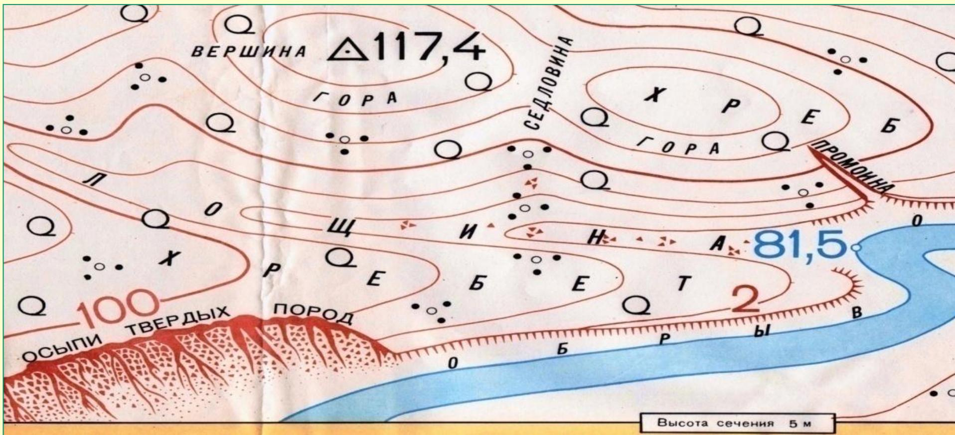
**КРУТИЗНА СКАТА (КС)** – угол наклона ската к горизонтальной плоскости. Отсюда следует: чем круче скат, тем больше угол наклона и меньше заложение
