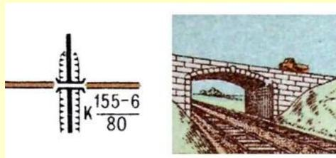
Путепроводы над железной дорогой: К – материал постройки, в числителе – длина и ширина проезжей части в метрах, в знаменателе – грузоподъемность в тоннах
