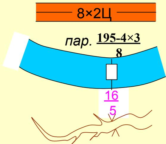
**Автострады:** 8 – ширина одной полосы в метрах; 2 – количество полос; Ц – материал покрытия
