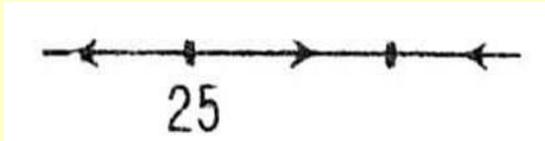
Линии электропередач на механических и железобетонных опорах (25 – высота в метрах)
