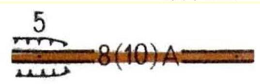
Усовершенствованное шоссе: 8 - ширина покрытой части; 10 - ширина всей дороги; А - материал покрытия; выемки (5 - глубина в метрах).
