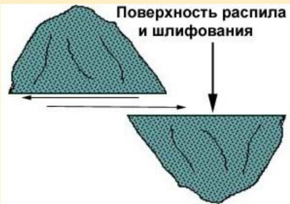
Распиловка исходного образца и шлифование одной из поверхностей распила.
