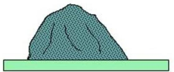
Наклейка образца шлифованной поверхностью на предметное стекло.
