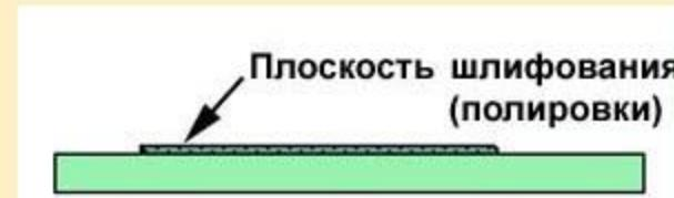
Сошлифование внешней поверхности образца до нужной толщины.
