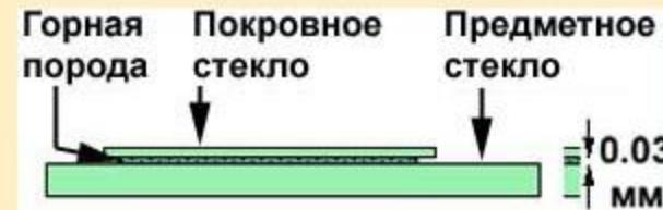
Наклеивание покровного стекла (для обычных шлифов)
