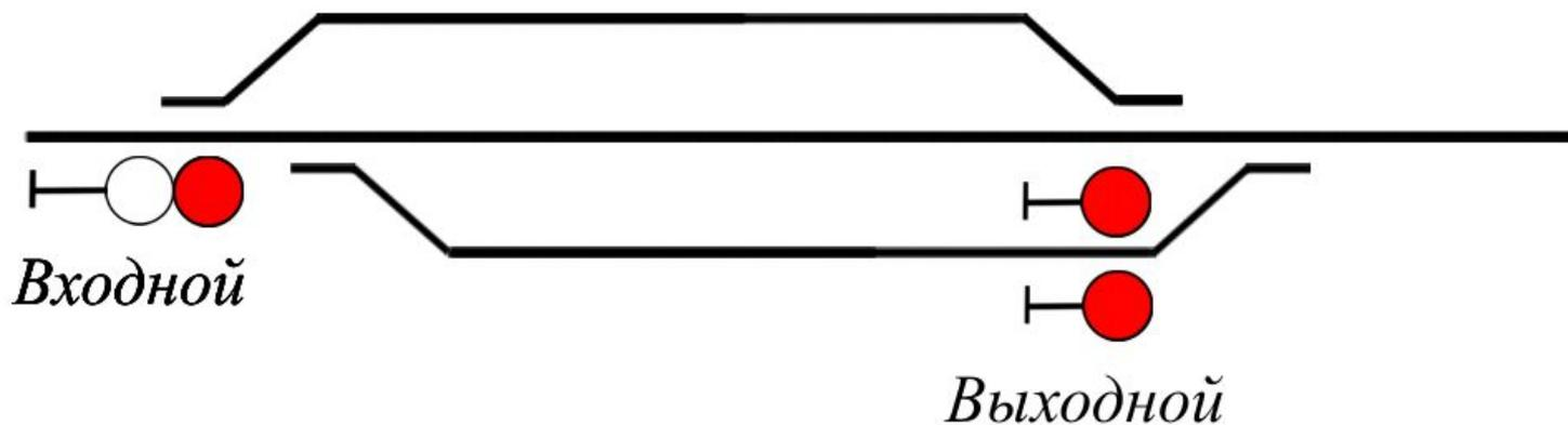
**Один желтый огонь** – «Разрешается поезду следовать на железнодорожную станцию по главному железнодорожному пути с готовностью остановиться; следующий светофор (маршрутный или выходной) закрыт»
