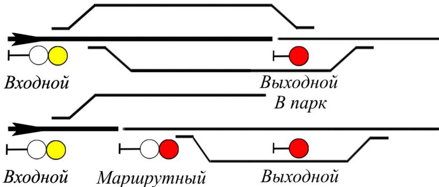
**Один желтый мигающий огонь** – «Разрешается поезду следовать на железнодорожную станцию по главному железнодорожному пути с установленной скоростью; следующий светофор (маршрутный или выходной) открыт и требует проследования его с уменьшенной скоростью»
