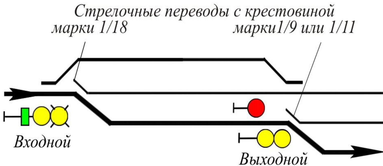
**Два желтых огня и одна зеленая светящаяся полоса** – «Разрешается поезду следовать на железнодорожную станцию со скоростью не более 60 км/ч на боковой железнодорожный путь и готовностью остановиться; следующий светофор закрыт»
