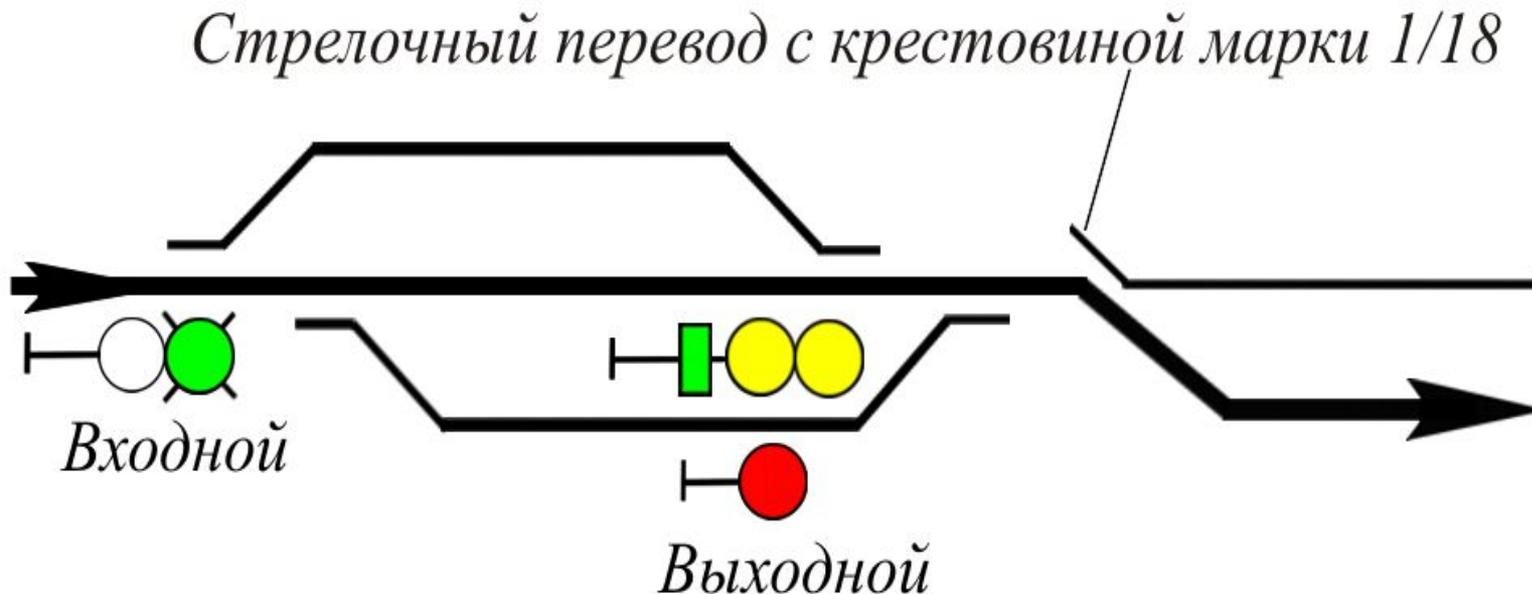
**Один зеленый мигающий, один желтый огни и две зеленые светящиеся полосы** – «Разрешается поезду следовать на железнодорожную станцию со скоростью не более 120 км/ч на боковой железнодорожный путь; следующий светофор открыт и разрешает проследование его с установленной скоростью»
