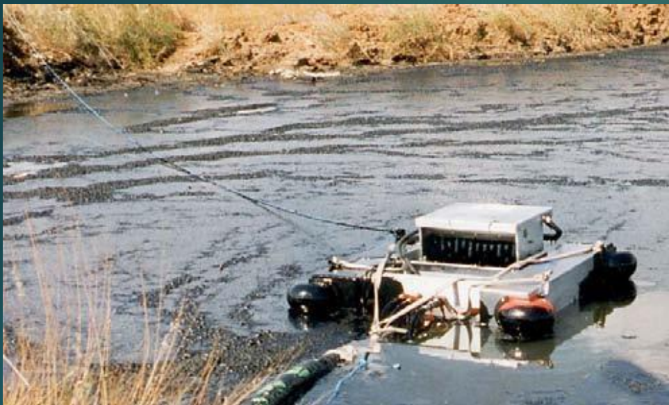
Сбор разлитой нефти по рельефу территории
