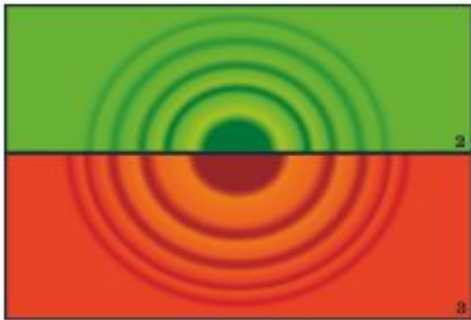
Рис. 1. Кольца Ньютона в отраженном свете: 1 — в белом, 2 — в зеленом, 3 — в красном
