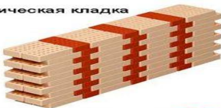
ложковая кладка косое смещение 1/4 кирпича
