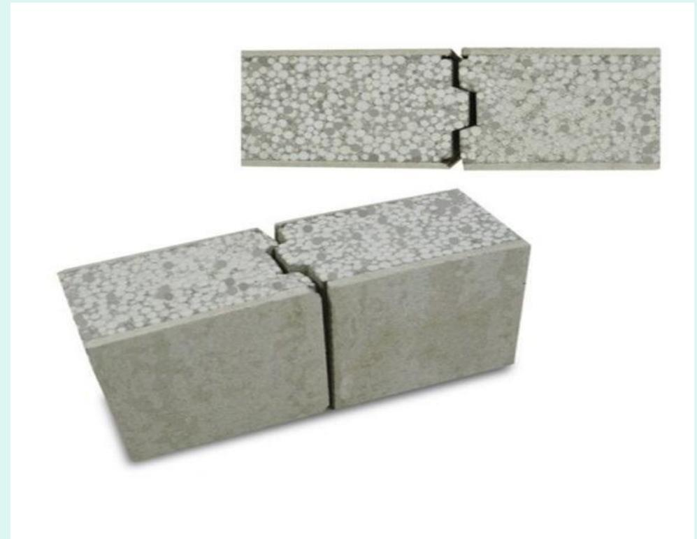
Сэндвич панель (EPS) с внутренним заполнением из цементного полистиролбетона и наружными слоями из цементных плит для наружных и внутренних стен каркасных и бескаркасных зданий
