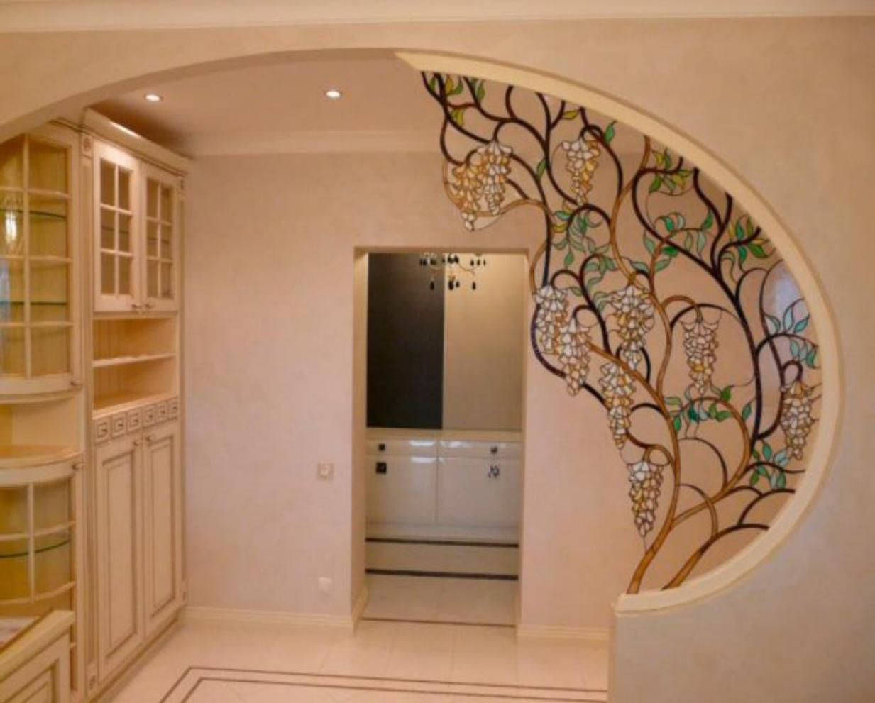
Комбинированная стационарная перегородка из гипсокартона и кованного металла
