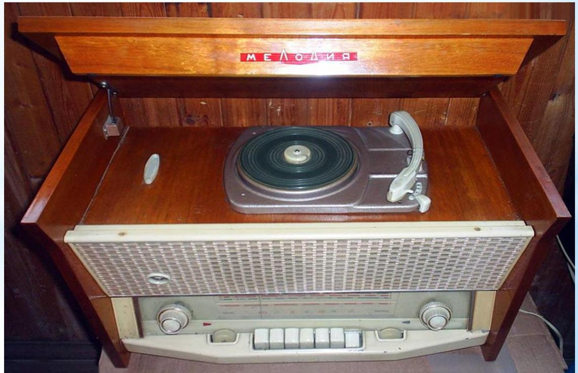
\* Радиола сетевая ламповая "Весна" с осени 1963 года выпускалась на Муромском заводе РИП. Диапазоны принимаемых волн: ДВ, СВ - стандартные, КВ - два поддиапазона и УКВ-ЧМ. Чувствительность приёмника 150...200 мкВ в АМ диапазонах и 20 мкВ в УКВ-ЧМ диапазоне. Избирательность в АМ диапазонах 34 дБ. Диапазон воспроизводимых звуковых частот при прослушивании УКВ-ЧМ станций и прослушивании грамзаписи 100...7000 Гц. Потребляемая мощность 50/60 Вт. Габариты радиолы 430x290x325 мм. Вес 13 кг.
