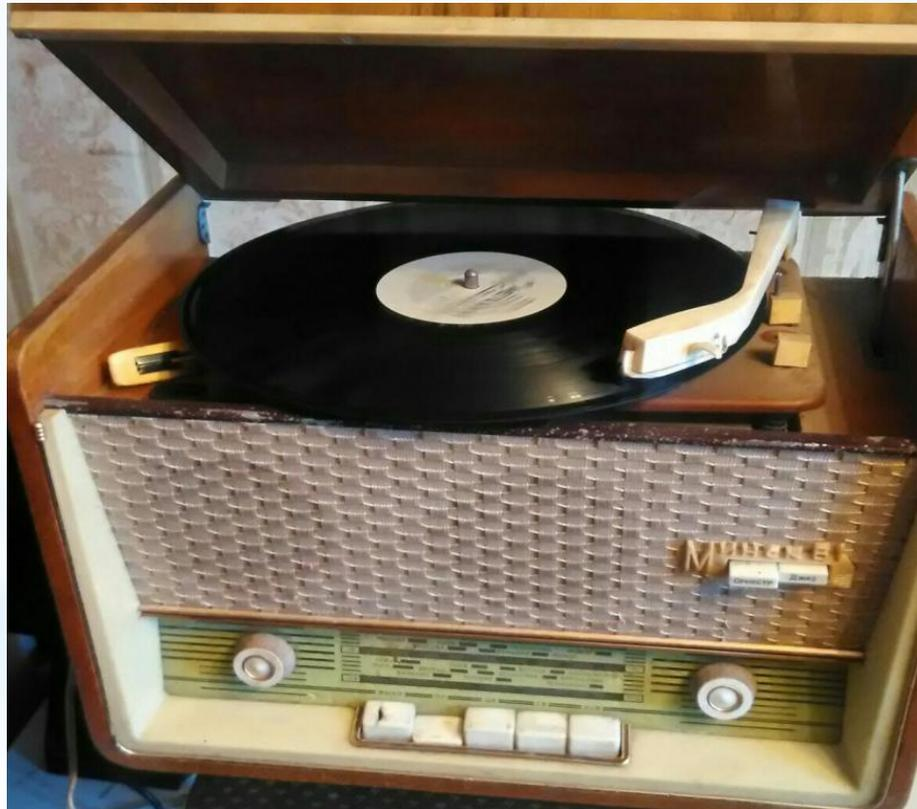
\* Радиоприёмник Сетевой ламповый "Рига-10" с 1952 года выпускал Рижский радиозавод имени А.С.Попова. Радиоприемник "Рига-10" - это десятиламповый, пятидиапазонный супергетеродин, обеспечивающий качественный приём радиовещательных станций в диапазонах ДВ, СВ, КВ. Приёмник можно использовать как усилитель с АС, для воспроизведения грамзаписи с внешнего электропроигрывателя. Число "10" в наименовании означает количество радиоламп.
