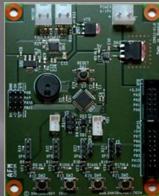
Система управления выполнена в виде мощного и надёжного промышленного микроконтроллера на базе чипа AFM (Advanced Forth Machine), внутри которого функционирует специальная система для создания и выполнения программ AFS (Advanced Forth System).
