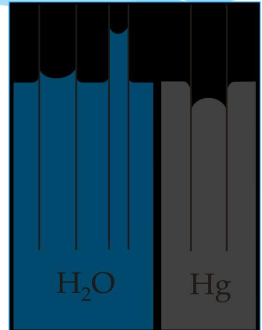
Капиллярными явлениями называют подъем или опускание жидкости в трубках малого диаметра – капиллярах.
