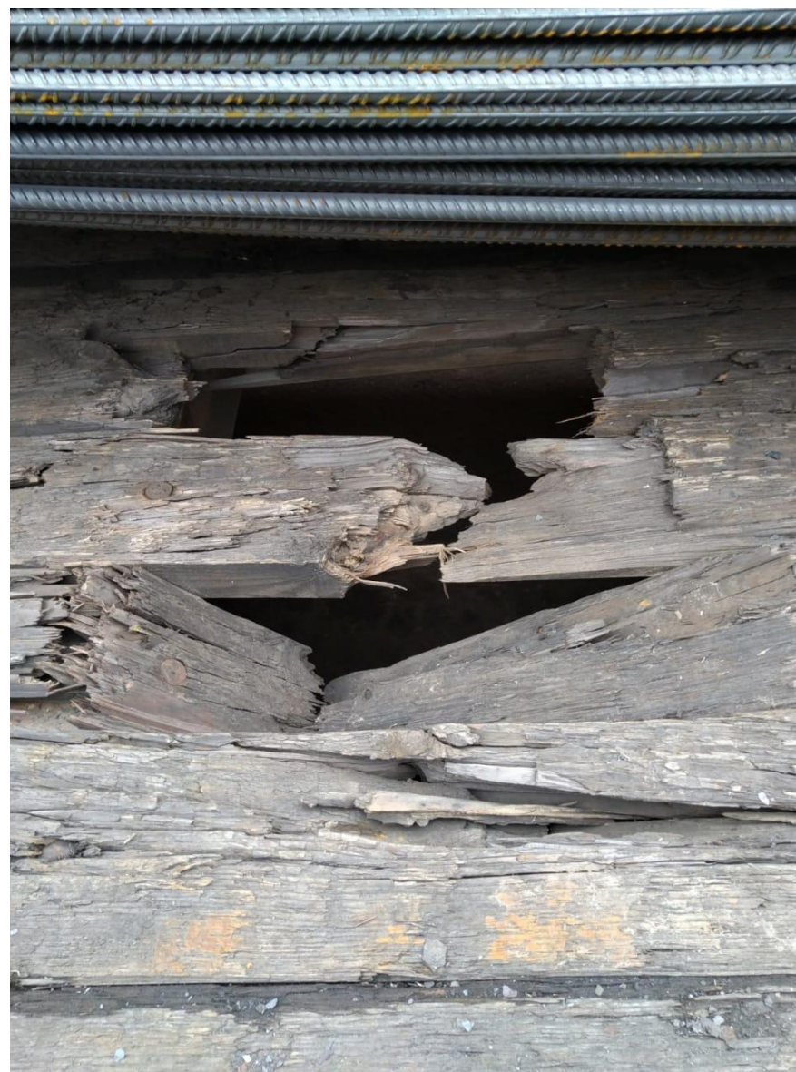
Эксплуатация поврежденного ролл-трейлера.
