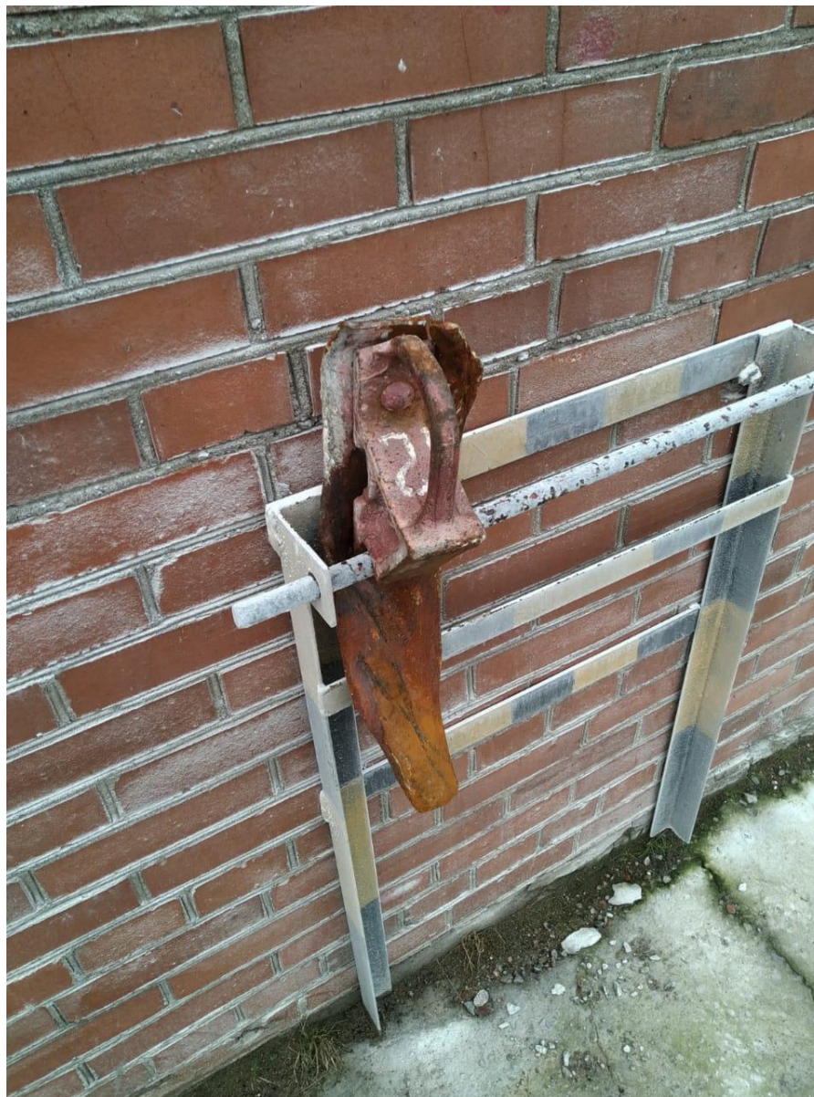
Хранение неисправного тормозного ж/д башмака.
