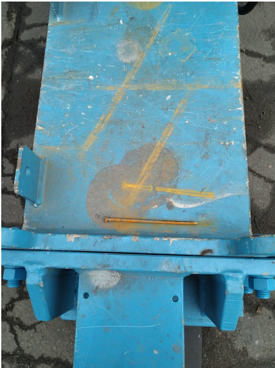
На порталном кране посторонние предметы (гвоздь, багор).
