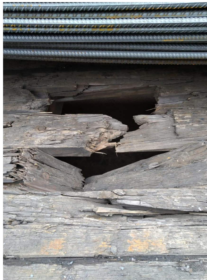
Эксплуатация поврежденного ролл-трейлера.
