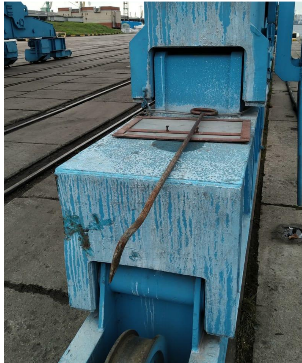
На порталном кране посторонние предметы (гвоздь, багор).
