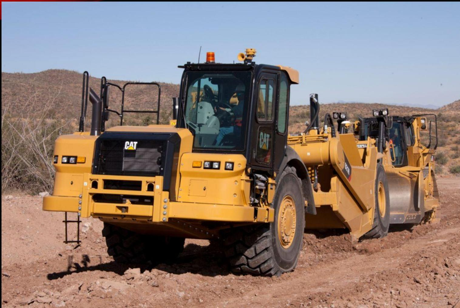
Быстрая загрузка, высокая транспортная скорость, а также возможность загрузки и разгрузки на ходу позволяют колесным тракторным скреперам Cat достигать высокой производительности при минимальной стоимости перемещения одной тонны материала.
