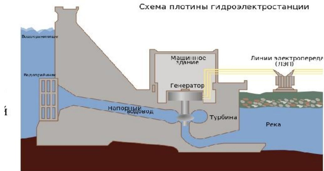
Гидравлической турбиной называется гидравлический двигатель, служащий для преобразования энергии потока жидкости в механическую энергию вращения вала турбины
