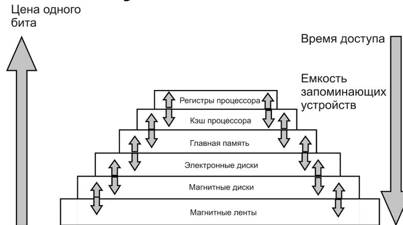
**Принцип локальности** или **локализации обращений** основан на свойстве реальных программ работать с небольшим набором адресов памяти в течение ограниченного отрезка времени.
