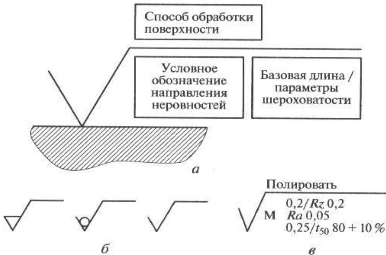
Рис. 1.14. Обозначение шероховатости на чертежах:
