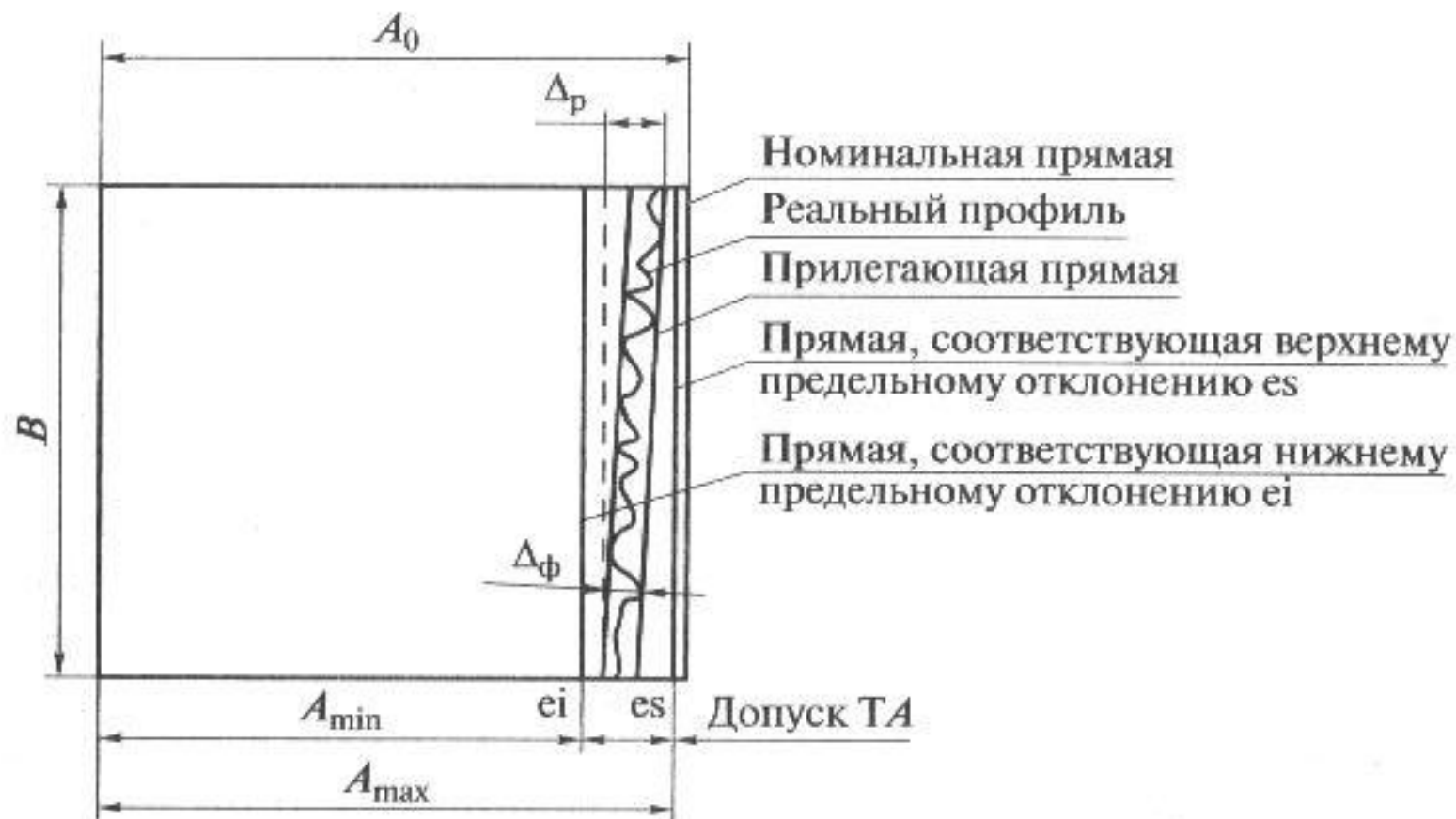
Рис. 1.10. Геометрическое представление допуска номинального размера, формы и расположения в сечении плоской детали
