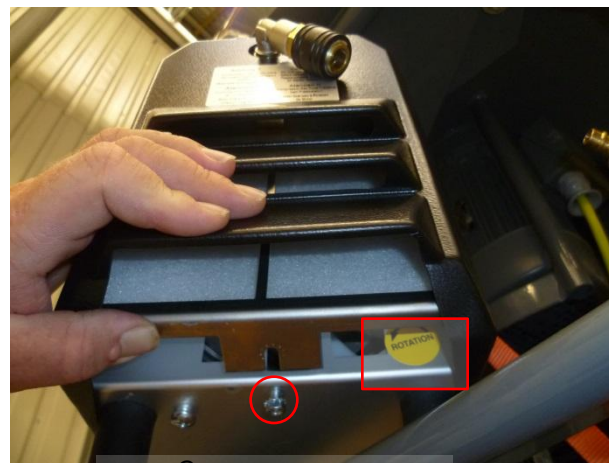
Сторона впуска охлаждающего воздуха
