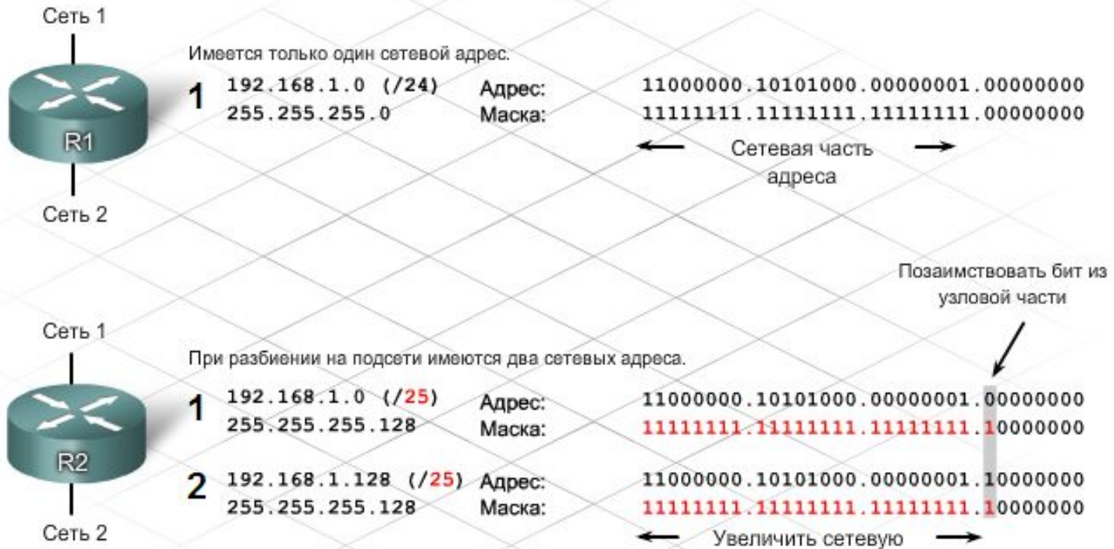
Схема адресации: Пример 2-х сетей
