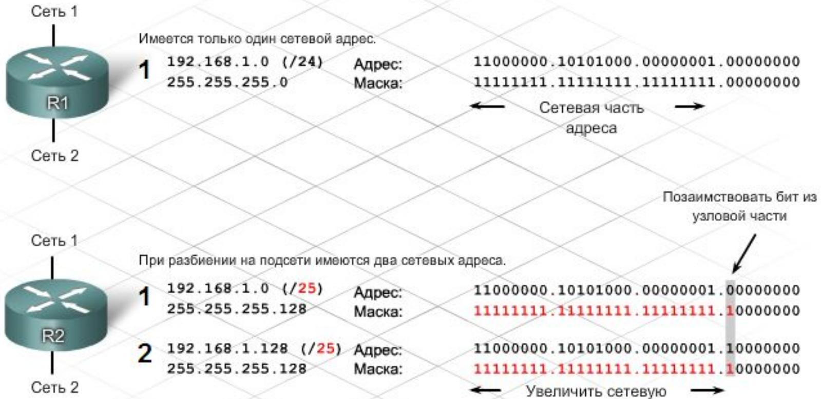
Схема адресации: Пример 2-х сетей
