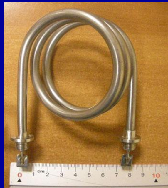
Рис.2.1. Нагрев сопротивлением косвенного действия
