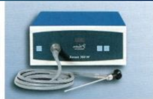
Рис. 2.3 Ксеноновый источник света с присоединенным оптоволоконным кабелем и оптикой
