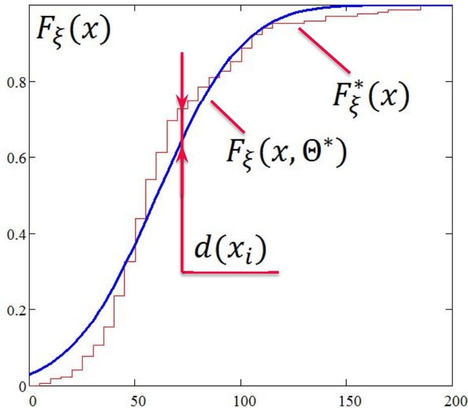
Минимизация нормы невязки:  $\|d(x)\|_{x \in [a, b]} \xrightarrow{\Theta} \min$
