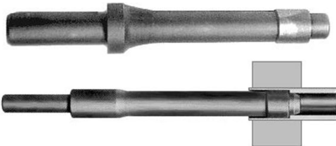
Рис.5.4. Оправка для удаления из трубных решеток труб после их обработки зенковками
