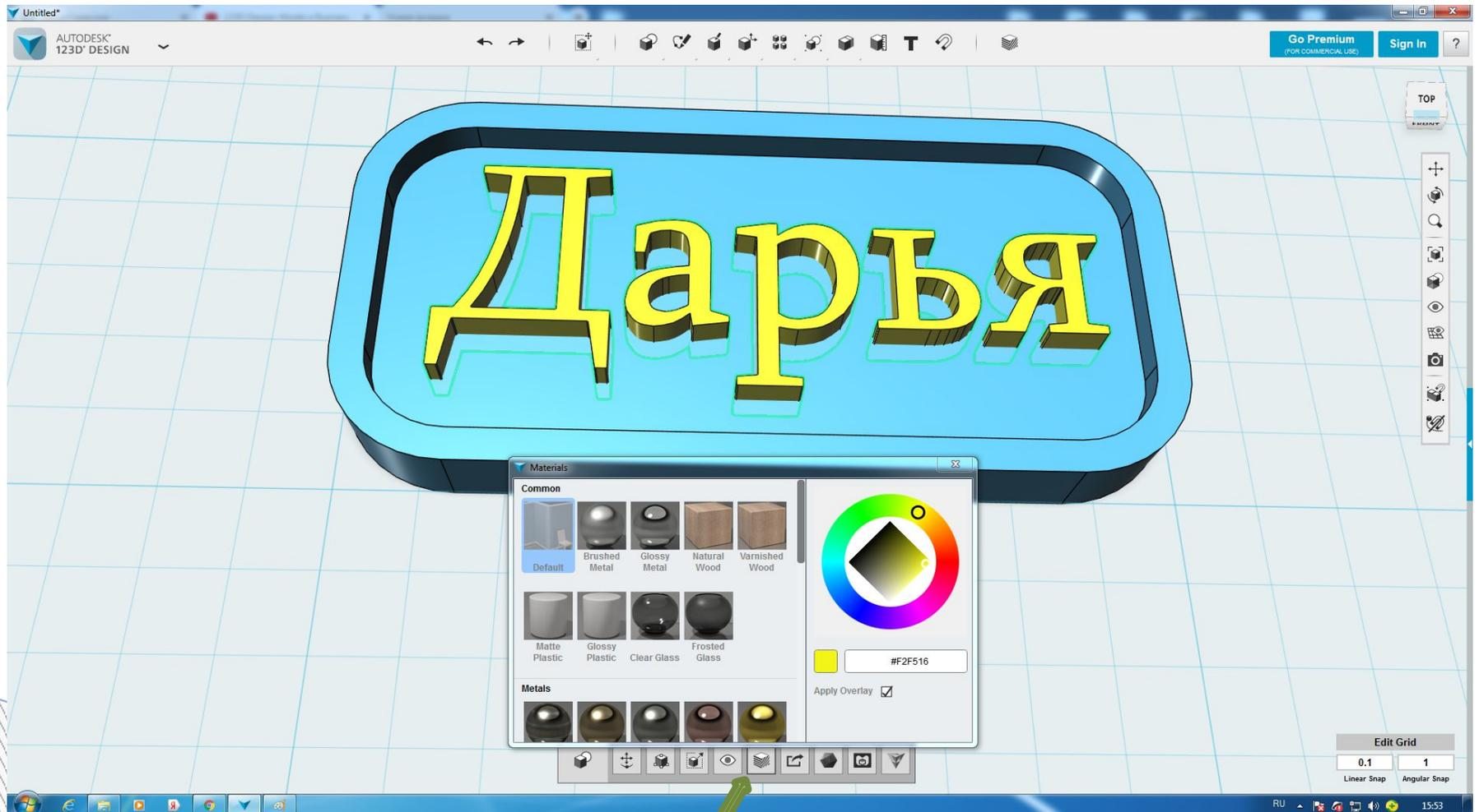
У всех брелков есть отверстие, с помощью которого мы можем повесить его на ключи. Давайте его тоже сделаем с помощью цилиндра. Ставим на рабочую плоскость фигуру и меняем его размеры. Высота = 5 мм ширина и длина = 4,5
