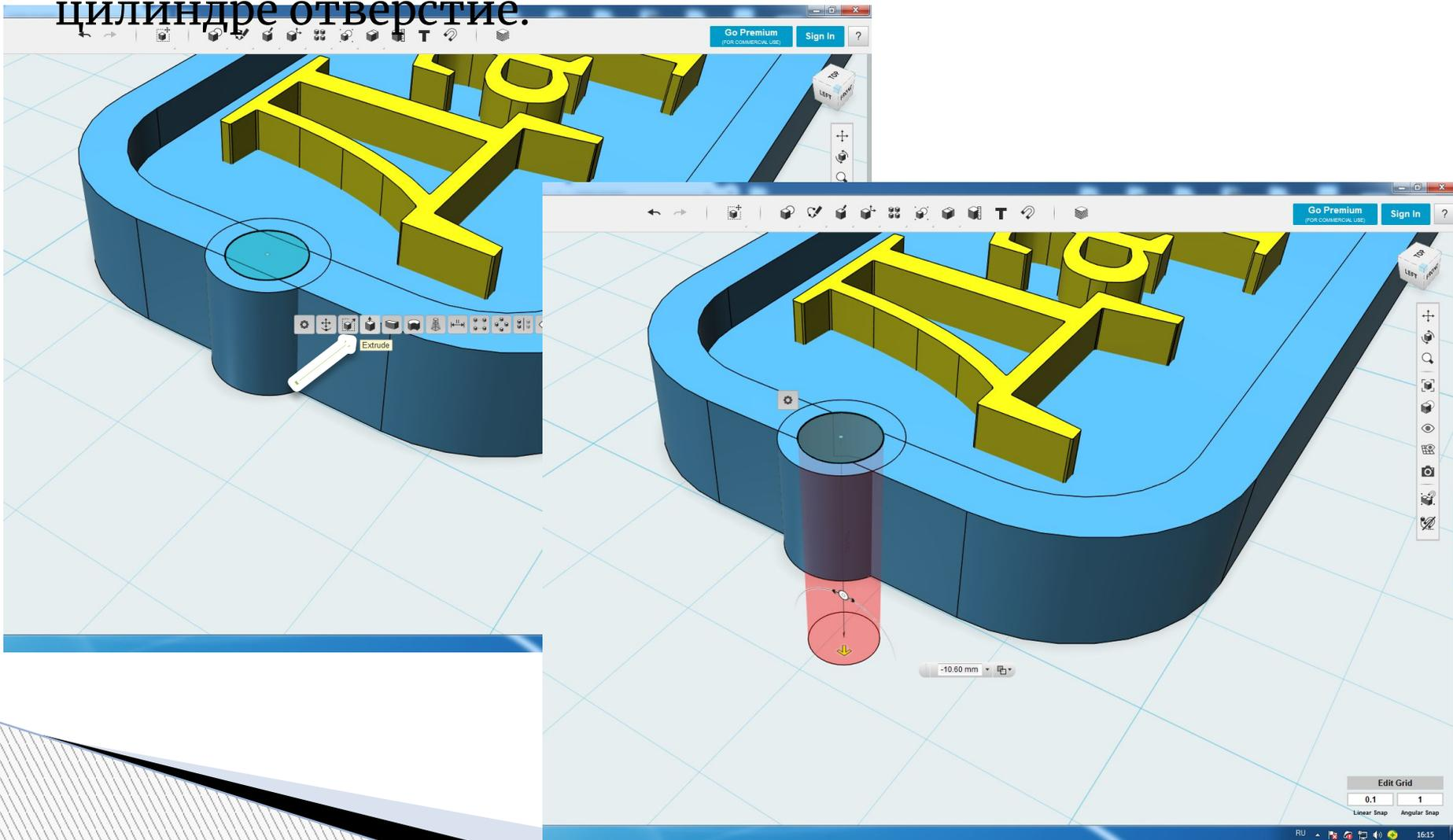
Выделяем цилиндр и основу брелка, как показано на первой картинке. Объединим эти две фигуры. В верхней панели ищем функцию «Combine» и выбираем «Merge».
