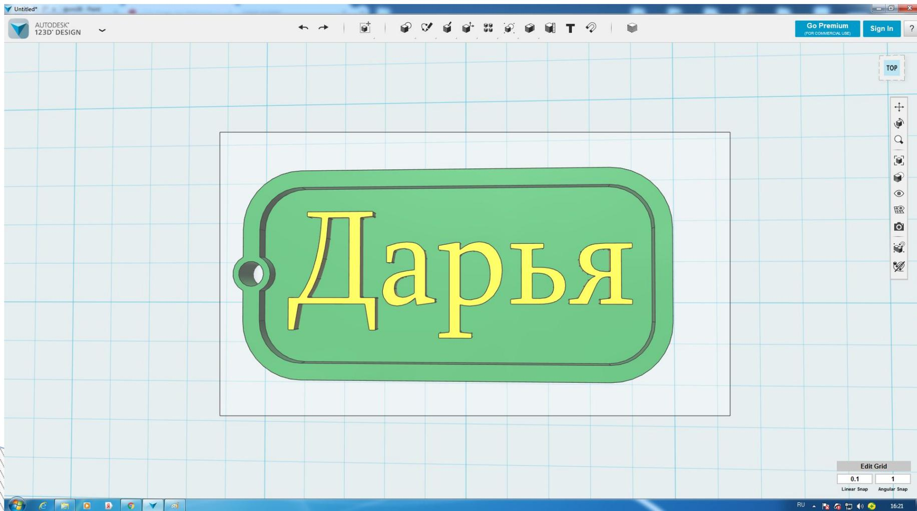
В верхней панели выбираем функцию «Grouping», первая из функций Group. С помощью этой функции все выделенные нами фигуры станут одним целым объектом.
