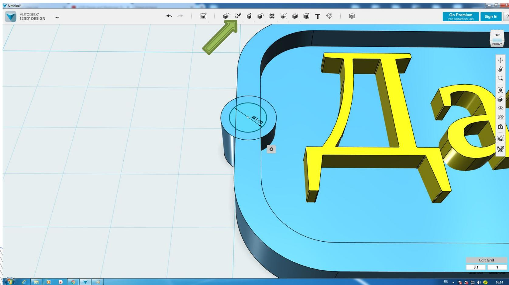
Выделяем нарисованный круг, нажимаем на высветившуюся шестерёнку и выбираем функцию «Extrude» и выдавливаем вниз тем самым делая в цилиндре отверстие.
