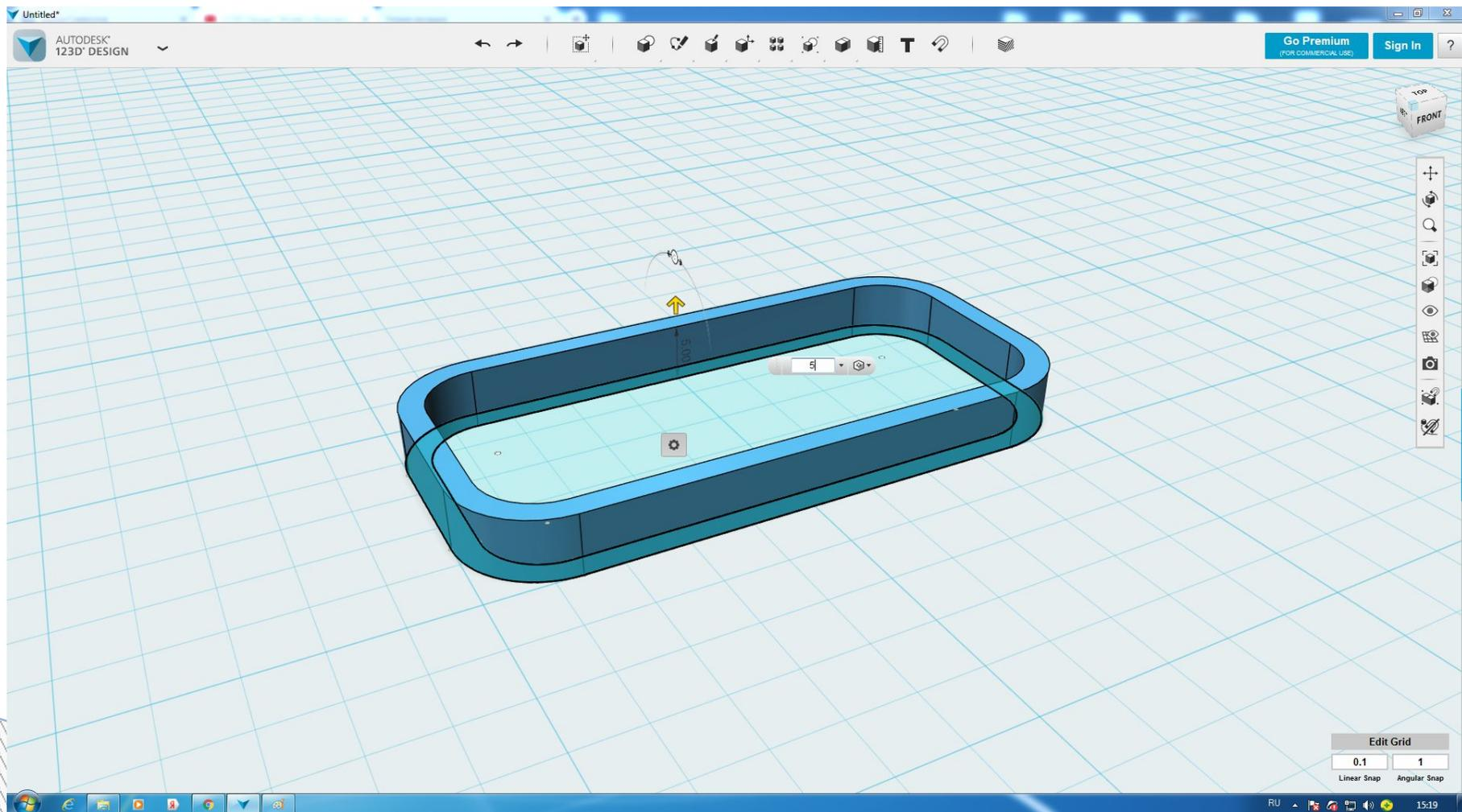
Так же выделяем нижнюю часть фигуры и так же вытягиваем вверх функцией Extrude. Вытягивает на 3 мм.
