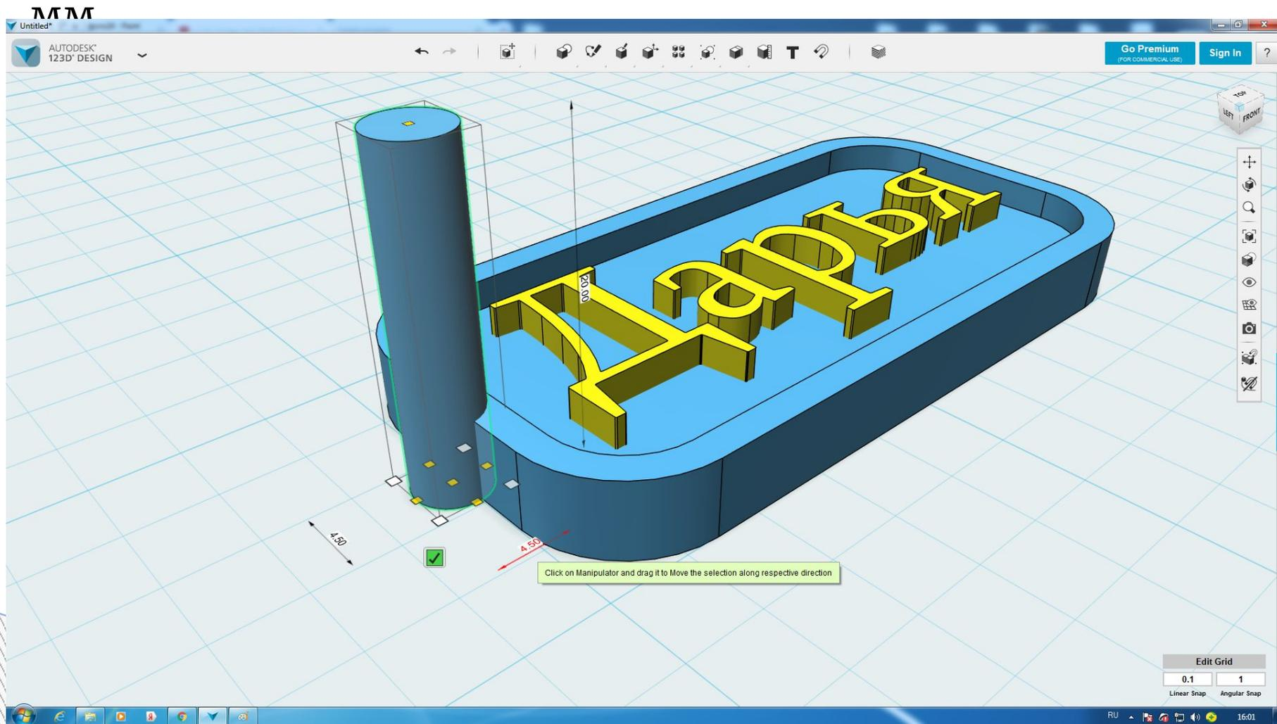
Отверстие получается на одной высоте с основой.
