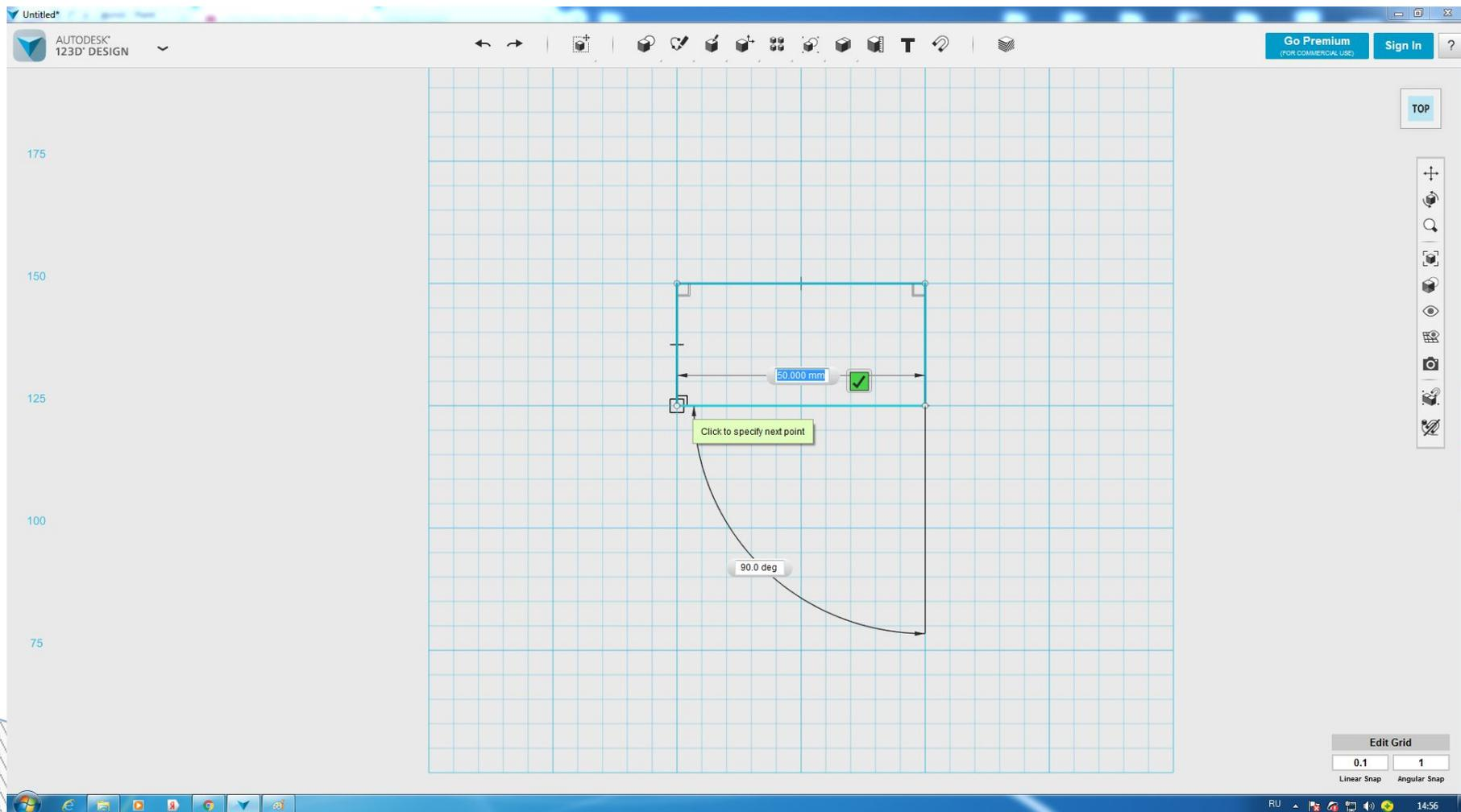
Теперь нужно скруглить края. Используя функцию «Sketch Fillet» мы по очереди скругляем все углы. В нижнюю табличку вносим цифру 7. Скругление на 7.
