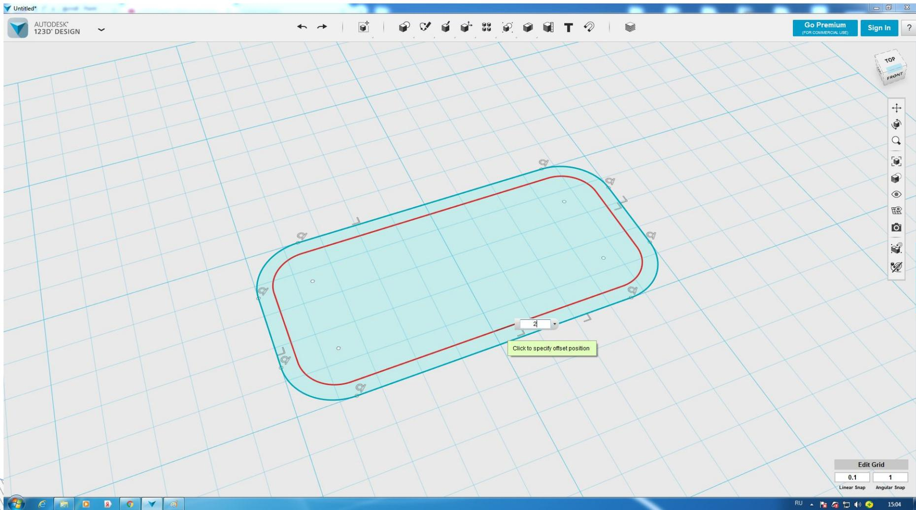
Выделяем фигуру как на фото. Нажмите на шестерёнку и высветится табличка с функциями. Тебе нужна функция Extrude. Выталкиваем вверх нашу фигуру на 5 мм.
